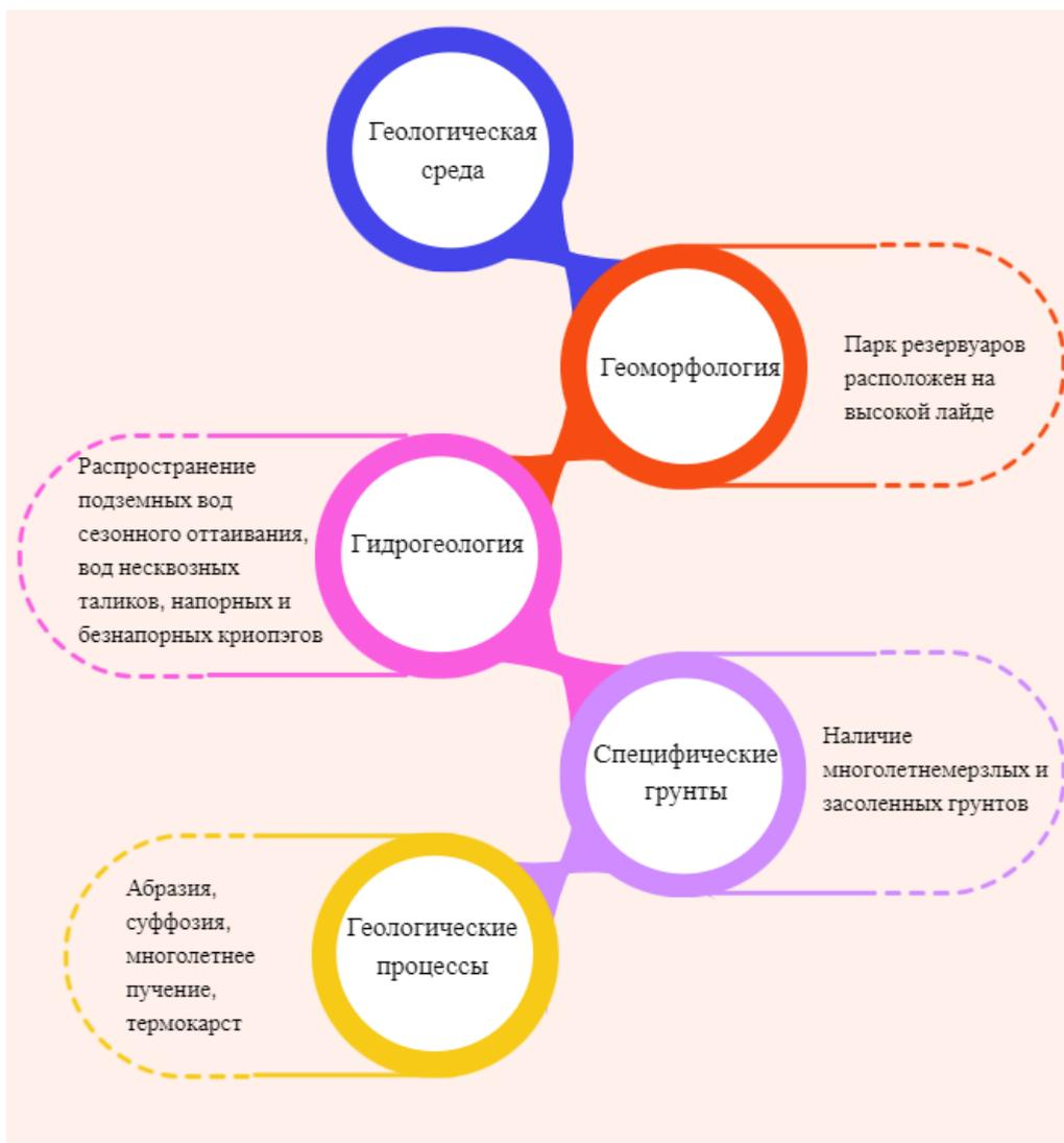
Рисунок 2 – Компоненты геологической среды на территории резервуарного парка
