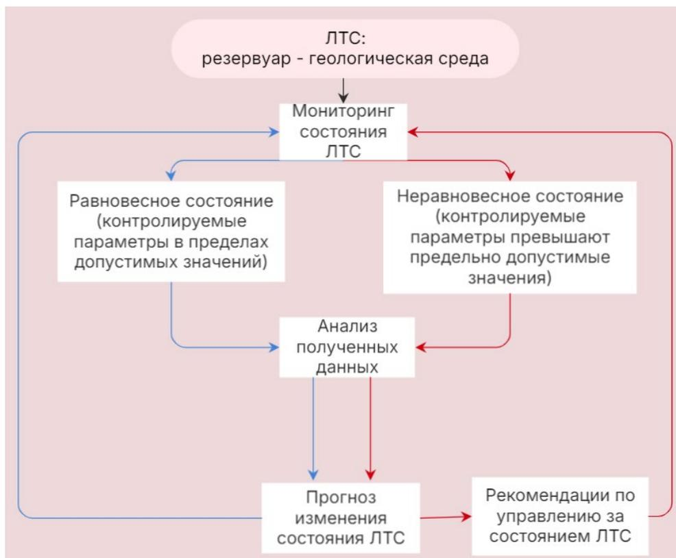
Рисунок 5 – Блок-схема реализации системы мониторинга за состоянием LTC
