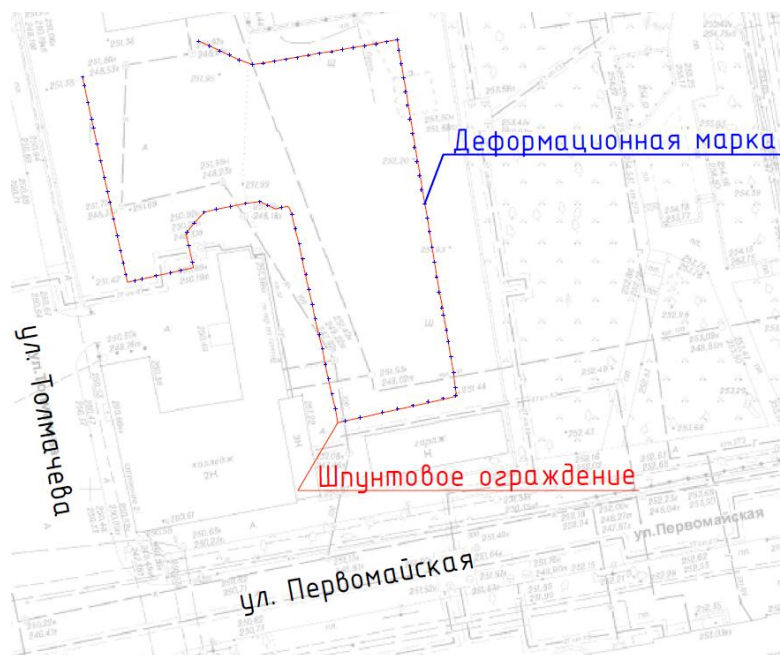
Рисунок 2 – Схема расположения шпунтового ограждения и деформационных марок
