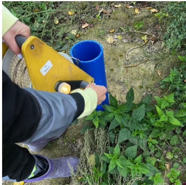
Рисунок 3 - Скважинный (погружной) уровнемер OTT KL 010
