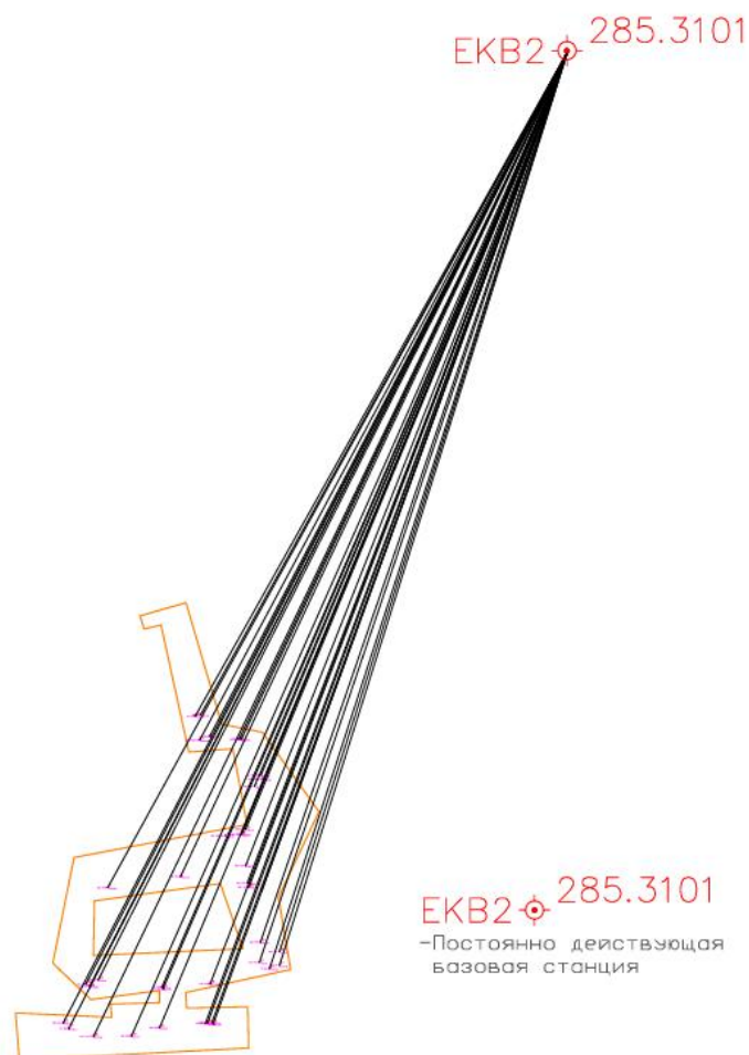
Рисунок 3 – Схема планово-высотного обоснования
