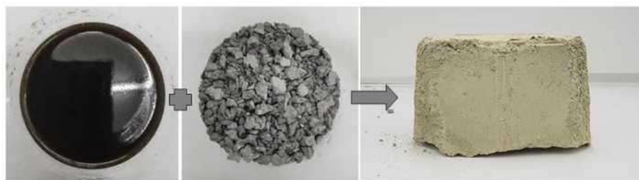
Рисунок 5 – Фильтрат полигонов ТКО, доменный шлак, полученный продукт литификации
