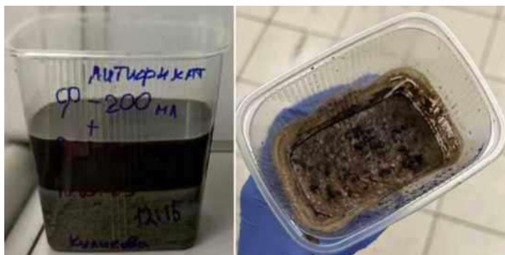
Рисунок 2 – Литификат в соотношении 1:1 фильтрата и доменного шлака: (а) – день приготовления смеси; (б) – 21 день твердения смеси
