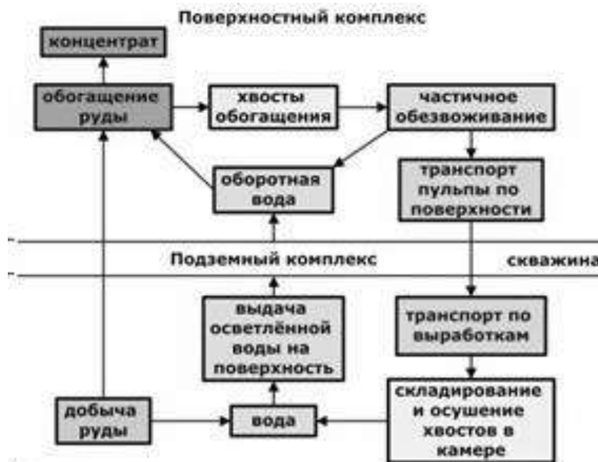
Рисунок 5 – Принципиальная схема технологии с замкнутым циклом обращения вещества рудной массы
