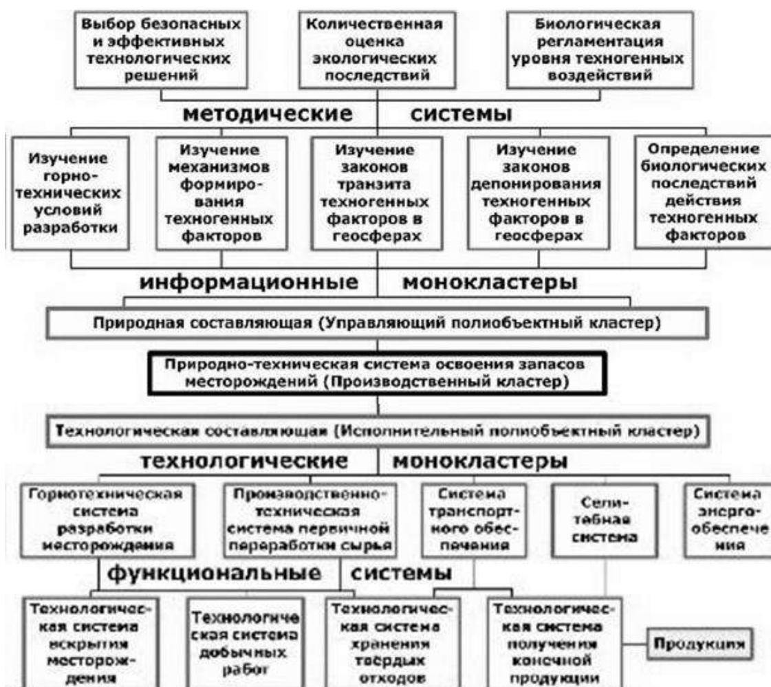
Рисунок 9 – Схема функциональной структуры природно-технической системы освоения запасов месторождений
