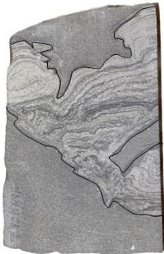
Рисунок 1 – текстурные особенности образца № 1: оползание и внедрение
