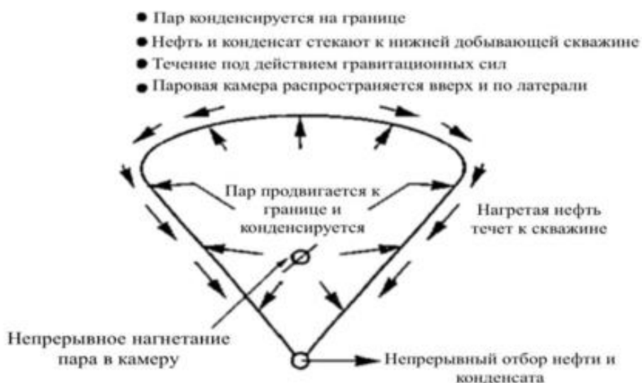
Рисунок 2 – Схема прогресса парогравитационного дренажа [3]
