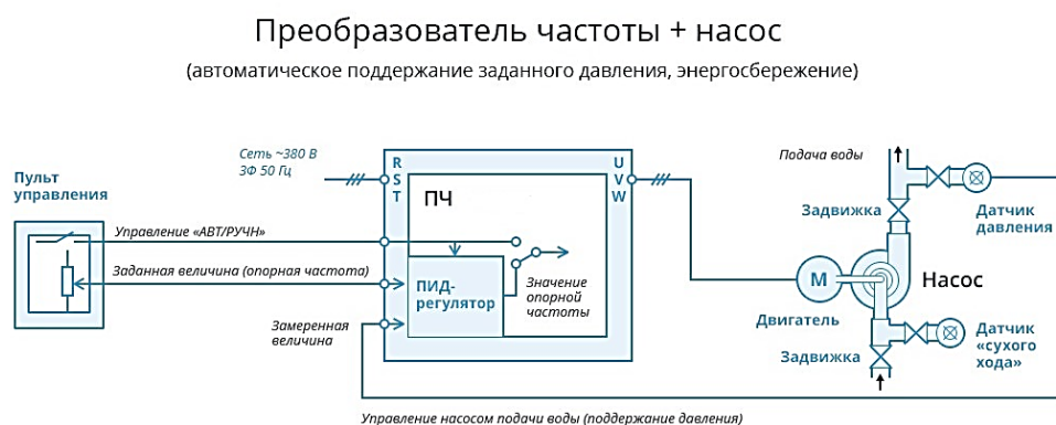
Рисунок 2 – Принцип работы частотного преобразователя и насоса
