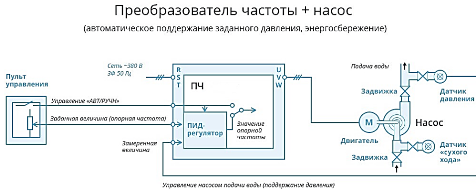
Рисунок 2 – Принцип работы частотного преобразователя и насоса
