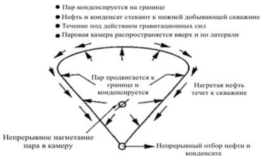
Рисунок 2 – Схема прогресса парогравитационного дренажа [3]
