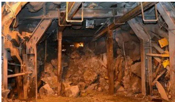
Рисунок 1- Обрушение и падение кусков полезного ископаемого и породы
