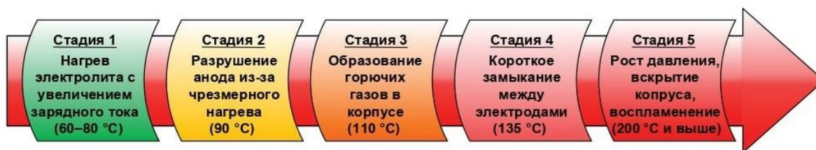
Рисунок 2 – Процесс теплового разгона литий-ионных аккумуляторов
