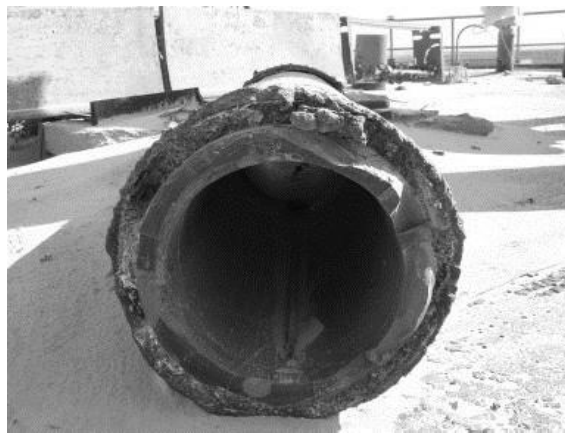
Рисунок. 2. Фотография трубы, футерованной каменным литьем
