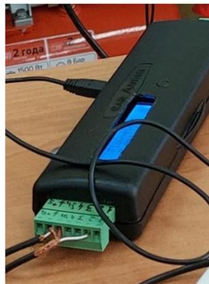
Рисунок 3 – Прибор для измерения давления и расхода в гидро- и пневмо-системах, разработанный на кафедре
