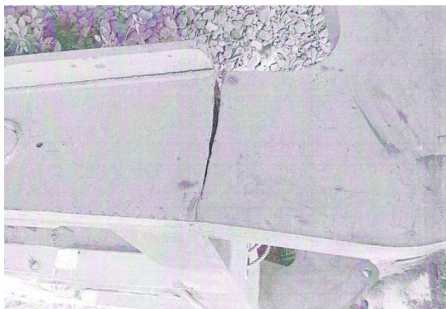
Рис. 1. Фотография места поломки ковша
