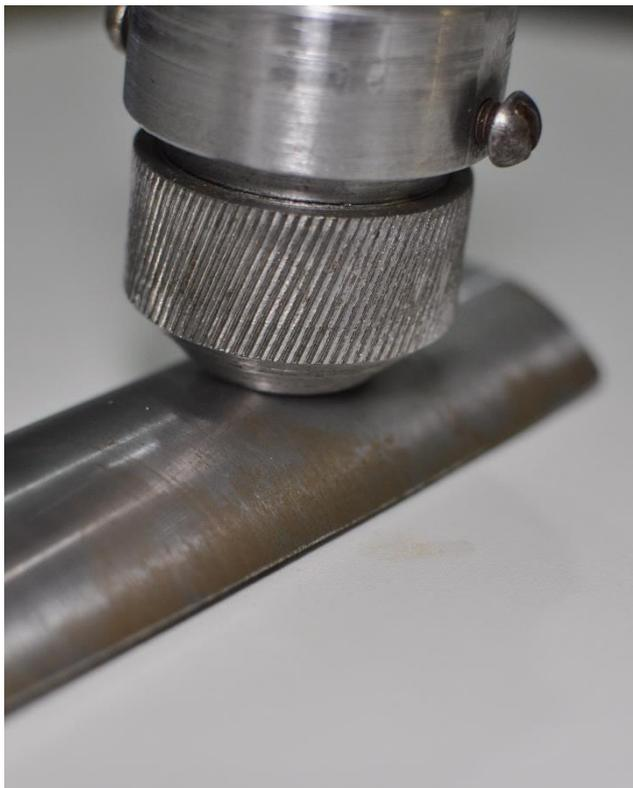
*Рисунок 2 – Зона контакта устройства ППУ и контрольного образца в процессе упрочнения*
