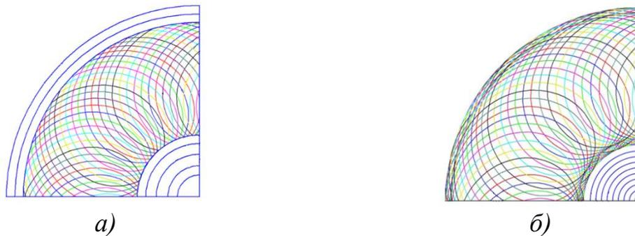
Рис. 2. Перекрестная схема резания плоско-дисковым исполнительным органом без гребенок (а) и с гребенками (б)
