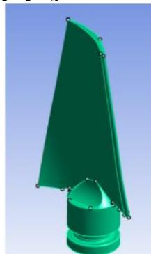
Рис. 2 Модель лопатки первого рабочего колеса
