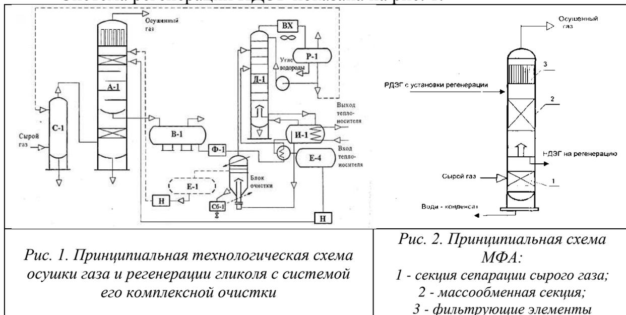
На УКПГ сеноманской залежи Уренгойского месторождения в эксплуатации находятся три основных аппарата осушки газа: ГП-252, ГП-365, ГП-502. Поэтому возникла необходимость провести анализ эффективности модернизации уже установленных абсорберов ГП-365, либо замены их более новыми модернизированными ГП-502 и ГП-778.
