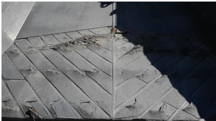
*Рис. 1. Износ дна кузова карьерного самосвала*
