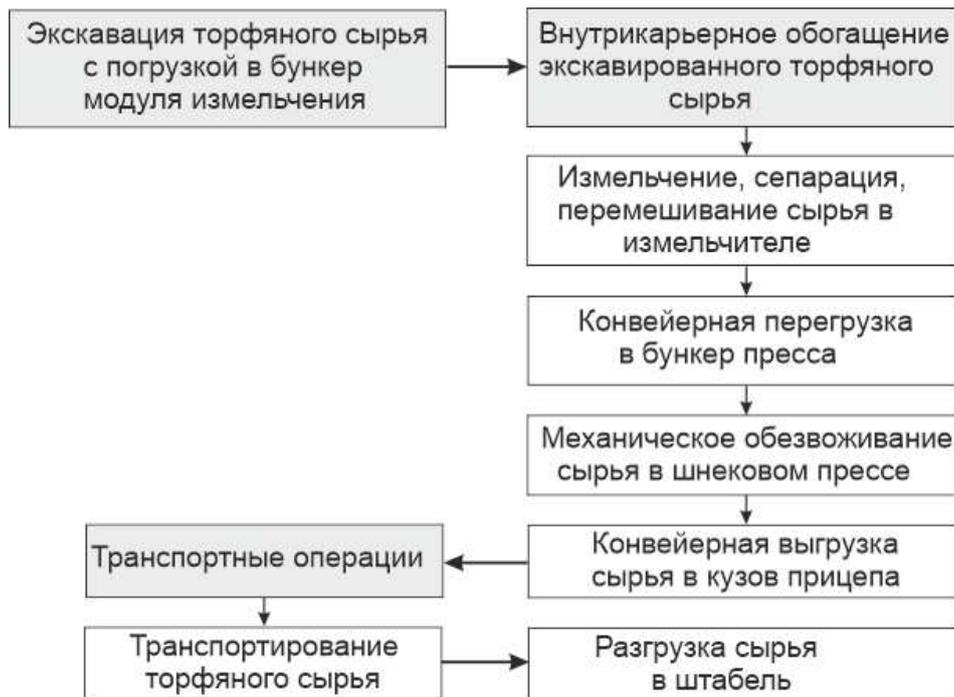
Рисунок 1 – Технологическая схема системы IPCCD [1]
