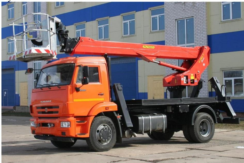
Рис.1 Автогидроподъемник на базе шасси КАМАЗ-4326
