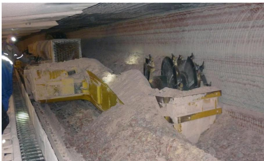
*Рис. 2. Работа двухшнекового очистного комбайна в лаве при селективной разработке плодородного пласта*
