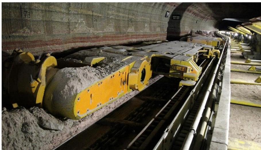
*Рис.1. Одновременная работа двух одношнековых очистных комбайнов левого и правого исполнения в низкой лаве*
