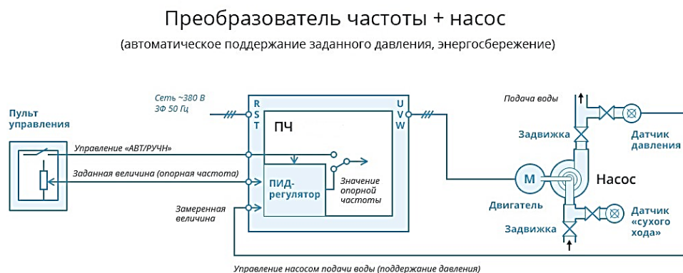
Рисунок 2 – Принцип работы частотного преобразователя и насоса
