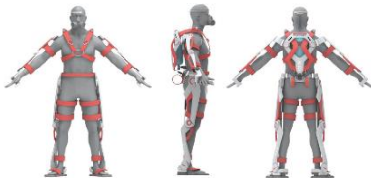
Рисунок 5- Противопожарный экзоскелет АФА
