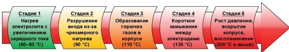
Рисунок 2 – Процесс теплового разгона литий-ионных аккумуляторов
