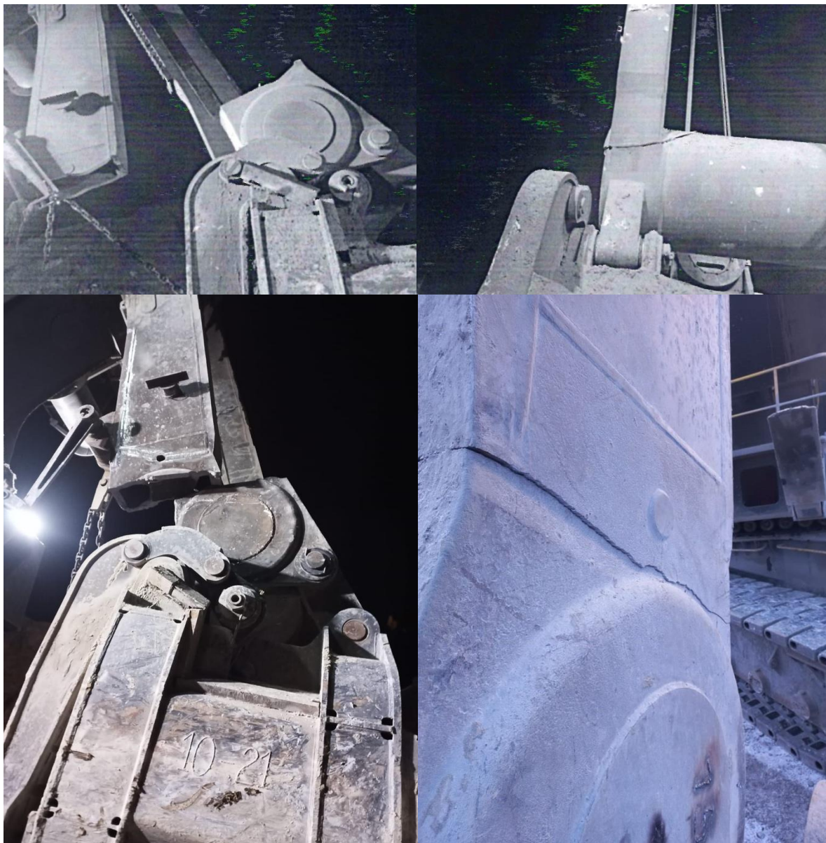
Рис. 1. Излом и трещинообразование балок рукояти ЭКГ-18Р
