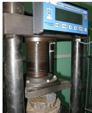
Рис. 3. Установка образца для испытания на внецентренное сжатие в гидравлический пресс ПГМ-1000МГ4
