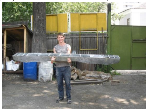
Фото 3. Композитная шпала массой 50 кг (бетонная – 300 кг.)
