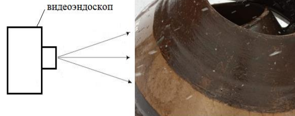
Рис. 2, б. Принцип реализации видеонаблюдения за состоянием футеровочной брони дробилки
