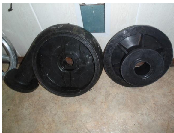
Фото 6. Корпус ц/б химстойкого насоса из композита
