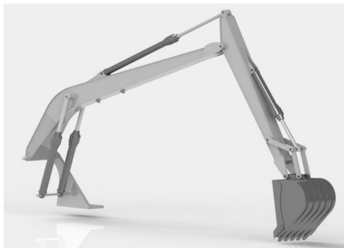
Рис. 5. Твёрдотельная модель рабочего оборудования экскаватора, созданная в среде Matlab Simulink
