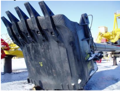
Рис. 1. Новые зубья на ковше экскаватора ЭКГ-8И
