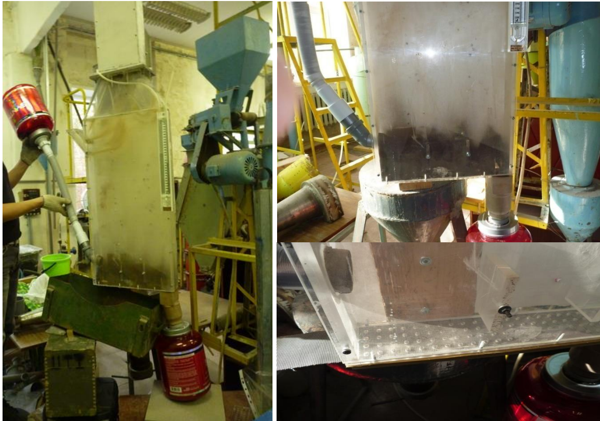
Рис. 4. Камера для создания псевдооживленного слоя с газопроницаемой поддерживающей пористой перегородкой
