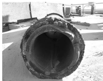
Рис. 2. Фотография трубы, футерованной каменным литьем:
