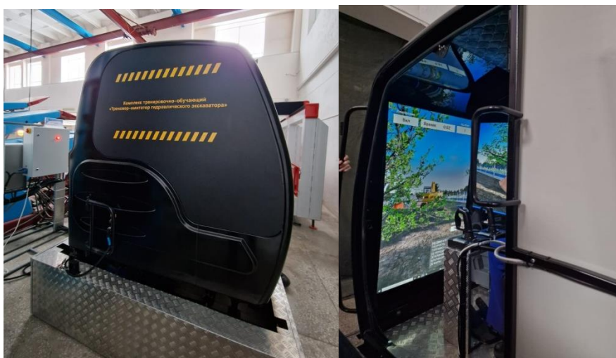
Рис. 1 – Общий вид тренажера-имитатора гидравлического экскаватора с обратной лопатой
