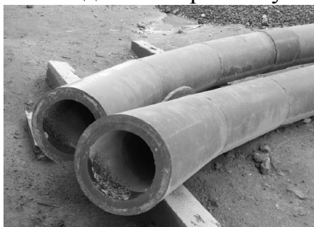
Рис. 2. Фотография трубы, футерованной каменным литьем:
