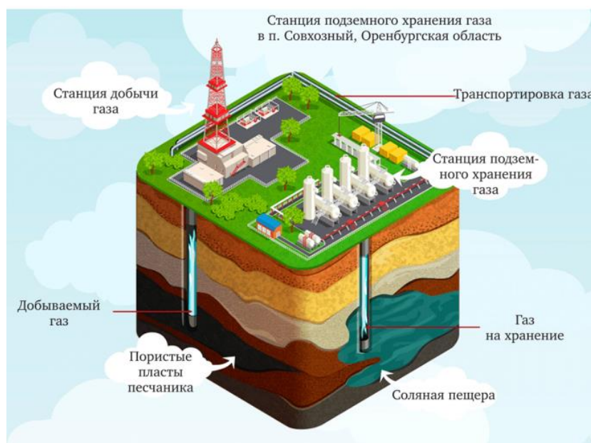
Рисунок 2 – Пример схемы хранения газа под землей.
