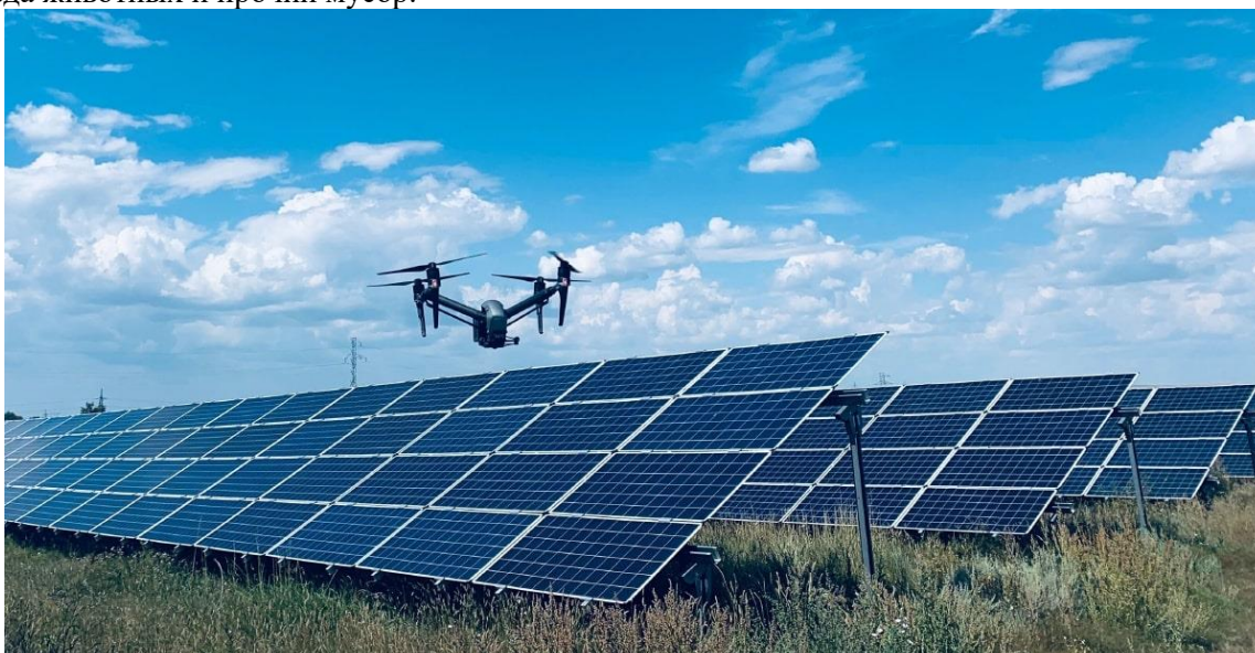
Рисунок 2 – БПЛА при осмотре солнечных электростанций
