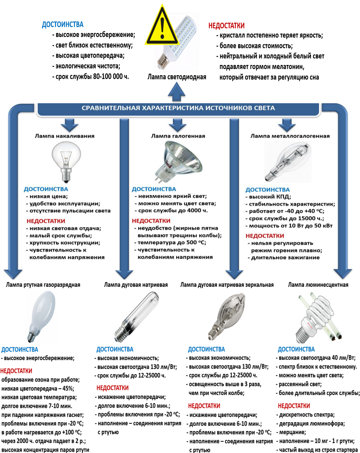
Рисунок 1 – Сравнительная характеристика источников освещения
