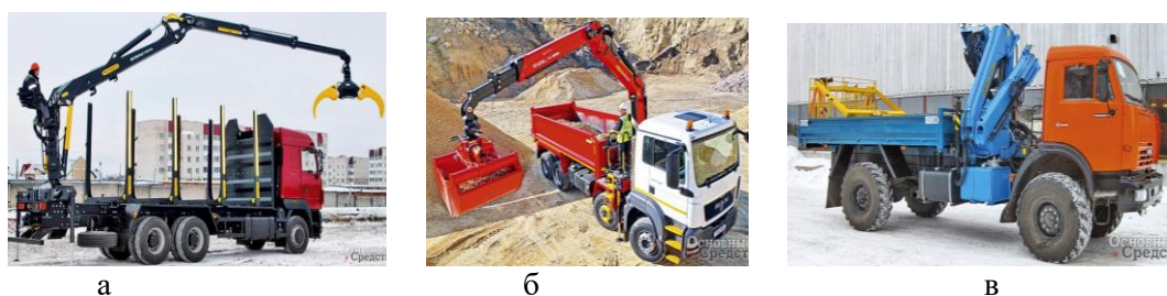
Рисунок 1 – Кран-манипулятор класса ВЕЛМАШ-VM10L86 - а, кран-манипулятор с грейфером – б, манипулятор с Z-образной стрелой
