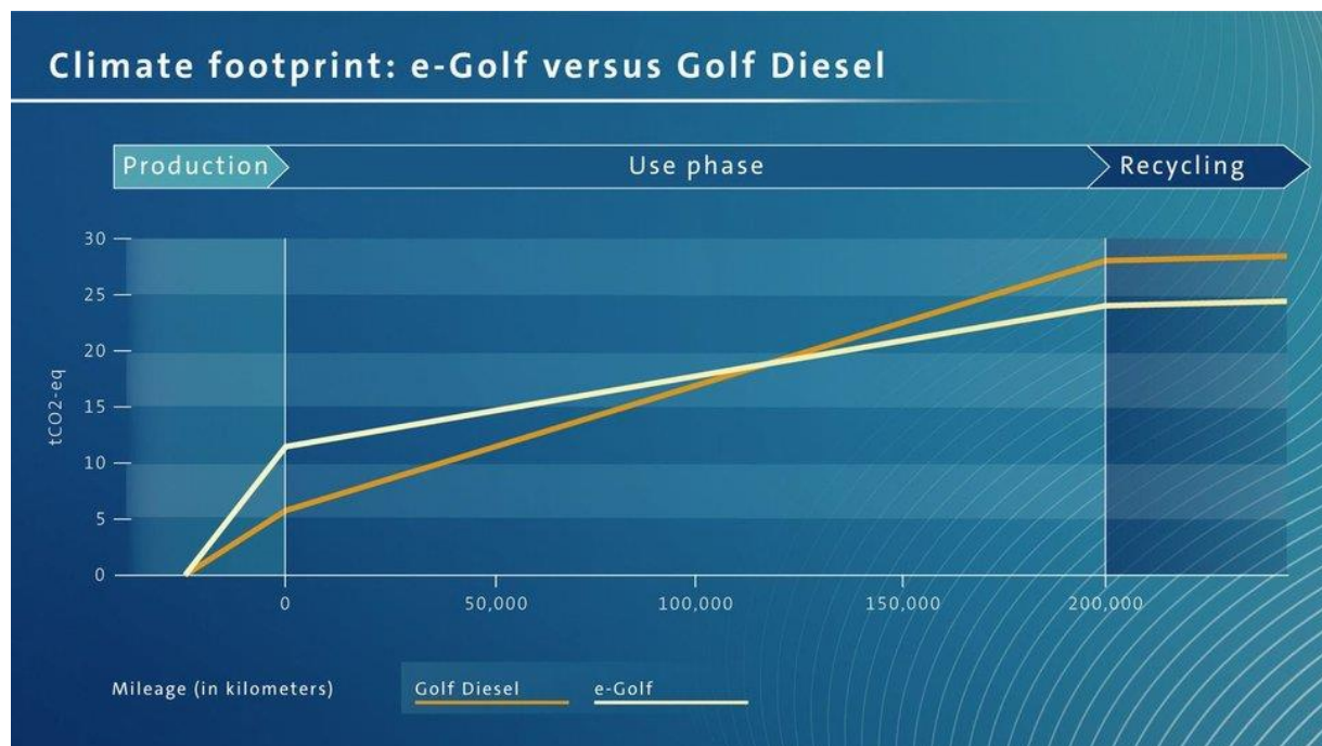
График 2 – Сравнение суммарного выброса CO 2 за весь цикл производства и эксплуатации дизельного Golf и его электрической версией
