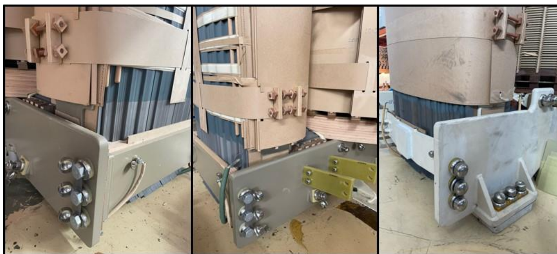
Рисунок 2 – Примеры предотвращения раскручивания соединения с помощью пластины
