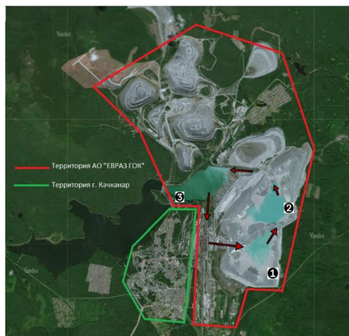
Рисунок - Схема очистки производственной воды на предприятии АО «ЕВРАЗ КГОК»
