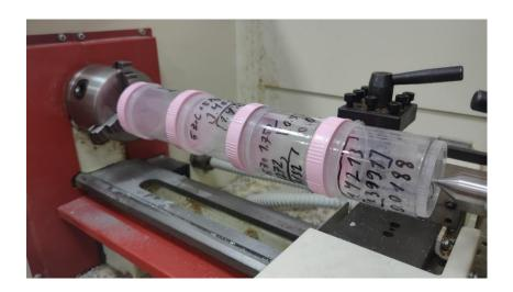
Рисунок 1 – Установка смешивания порошка
