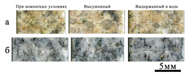
Рисунок 1. Развитие трещин в лабораторных образцах при изгибе: а – сиенит; б – серый гранит.
