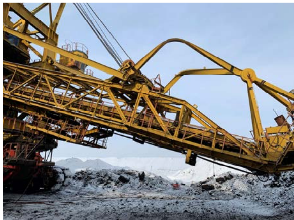
Рис. 1 Деформация верхнего пояса стрелы ЭРП-1600
