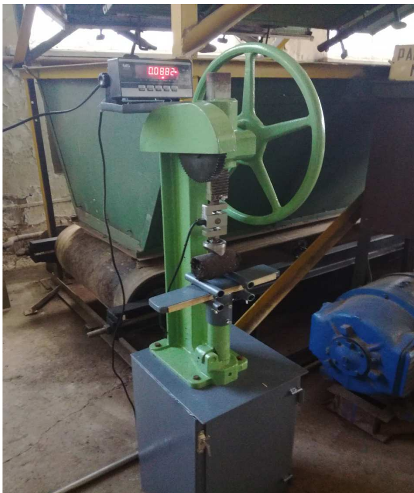
Рис. Испытание на изгибную прочность образцов кускового торфа
