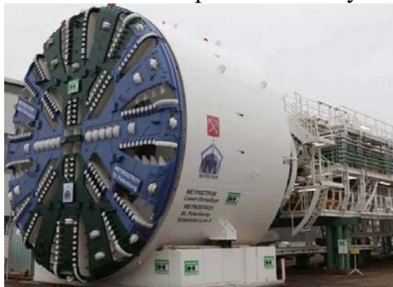
Рисунок 1. Тоннелепроходческий щит Herrenknecht S-782
