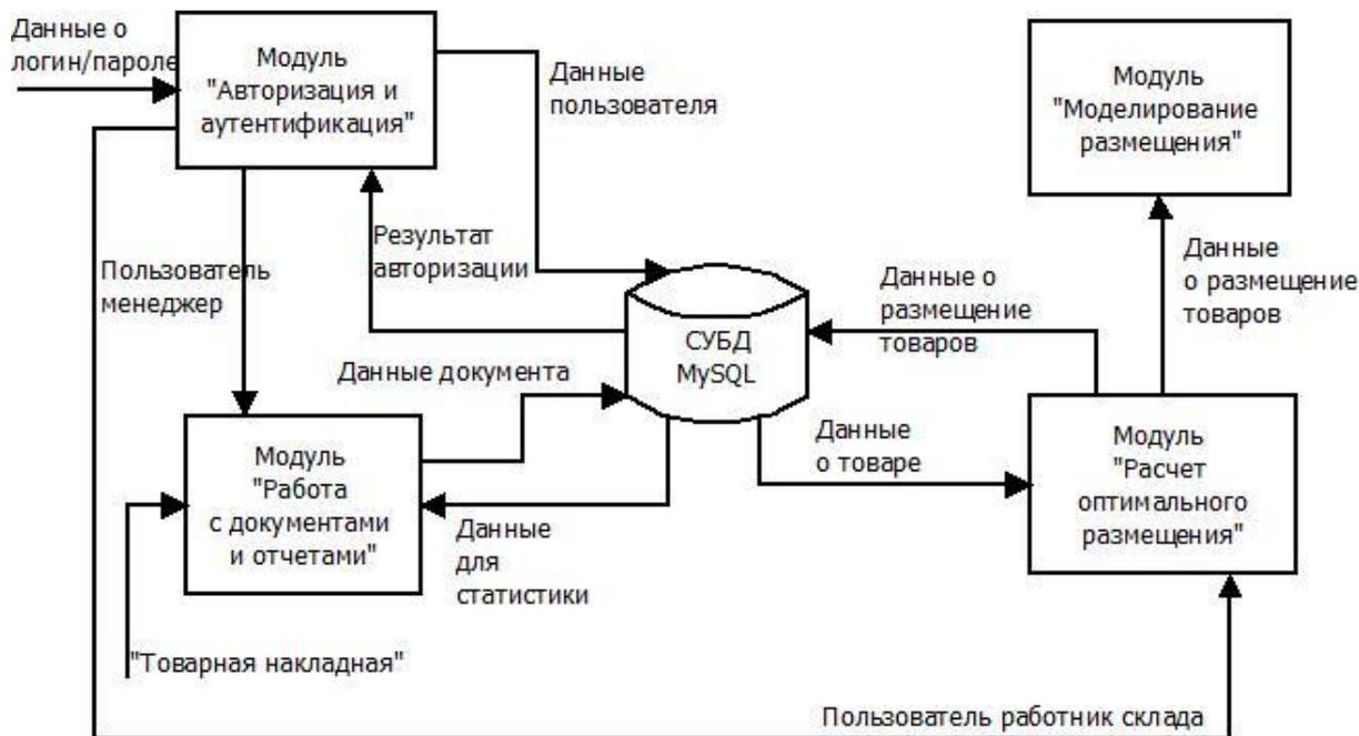
Рисунок 1 - Структура модуля оптимального размещения товаров на складе
