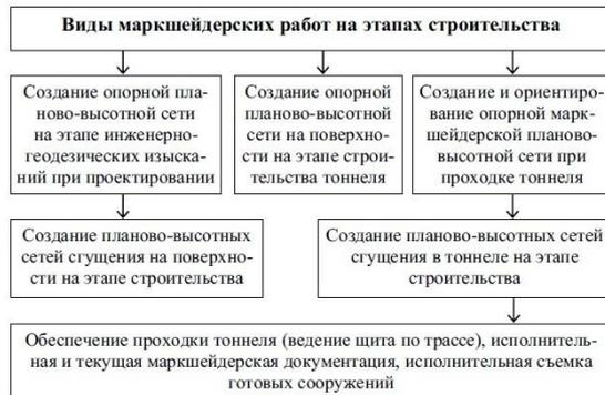
Рисунок 2 Виды маркшейдерских работ на этапах строительства, регулируемых нормативными документами
