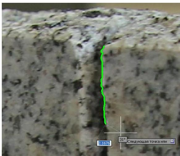
Рисунок 1 - Наложение полилинии на контур трещины
