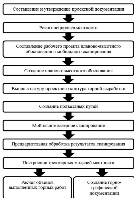
Рисунок 2 – Блок-схема технологии построения трёхмерных моделей местности, создания горно-графической документации и расчета выполненных горных работ по данным мобильного лазерного сканирования
