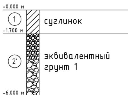
Рисунок 2 – Объединение двух смежных слоёв грунта при расчёте
