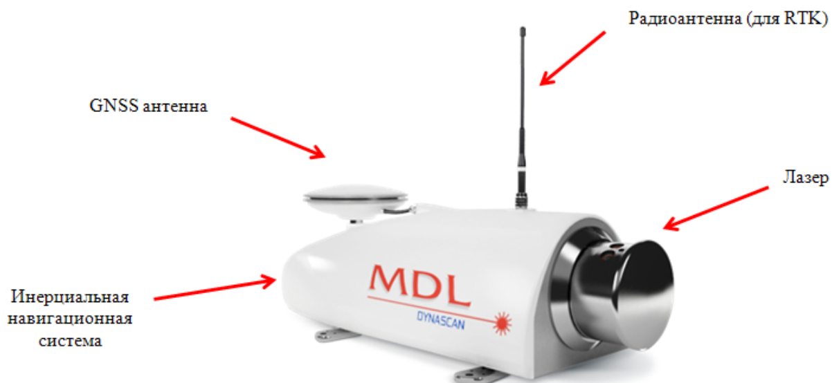
Рисунок 1 – Основные компоненты системы мобильного сканирования Dynascan (RT3005G)
