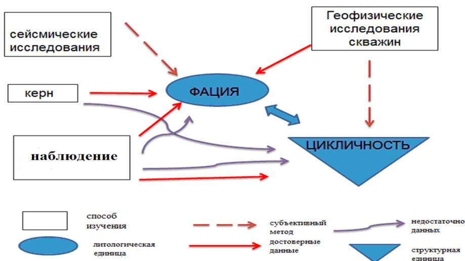
Рисунок 1 – Комплекс методов изучения осадочных образований, позволяющих определить фации и цикличность
