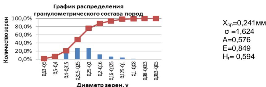
Рисунок 3 – Гистограмма распределения зерен по фракциям и кумулятивная кривая
