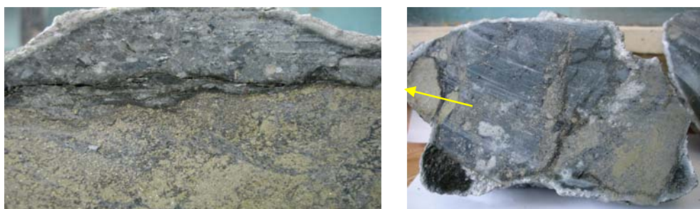
Движения выщелачивающих растворов внутри куска вкрапленной руды. Стрелкой показано гнездо минерального агрегата, полностью смытое растворителем
