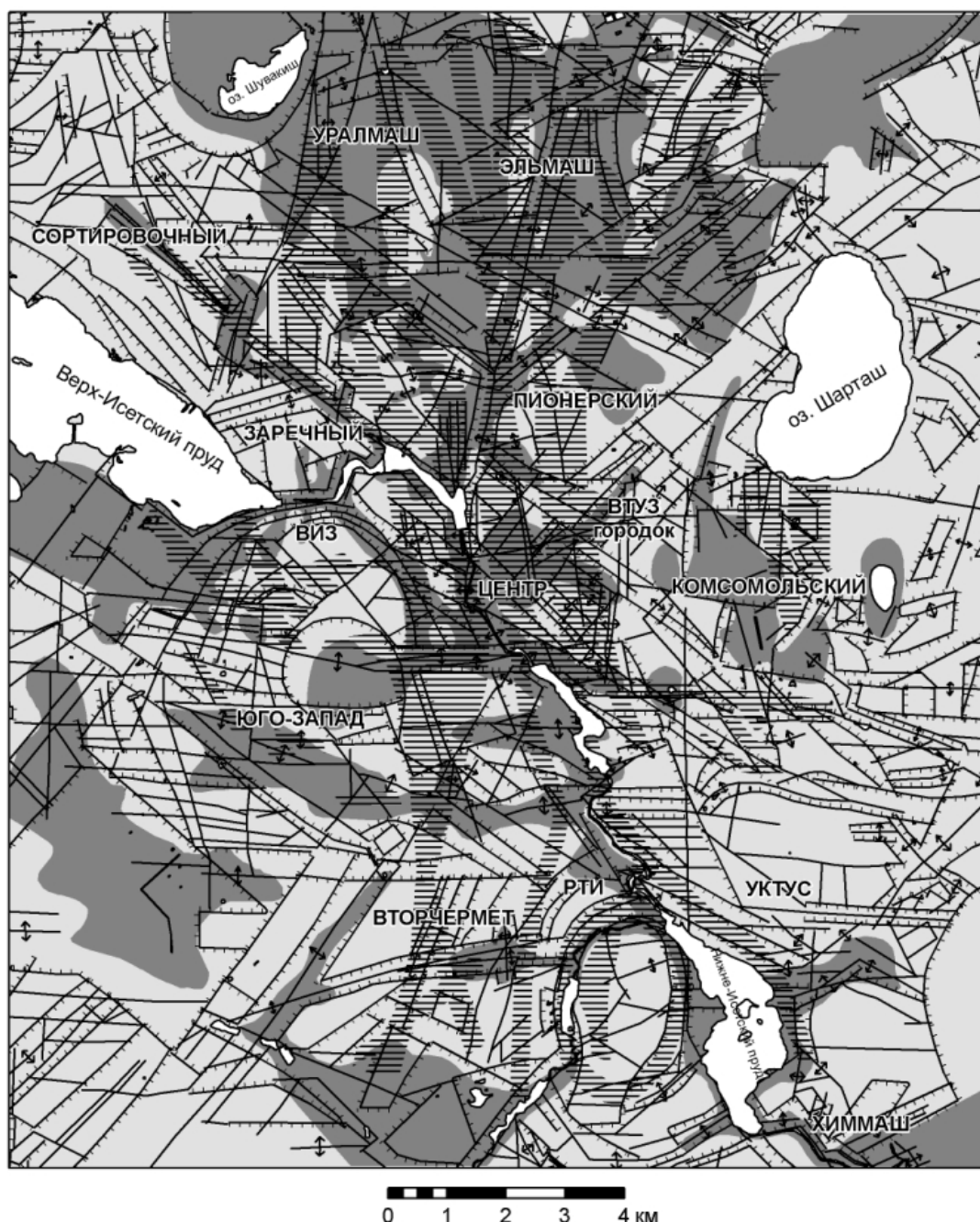
Рис. 1. Районирование Екатеринбурга по величине расчетной силы сейсмического воздействия
