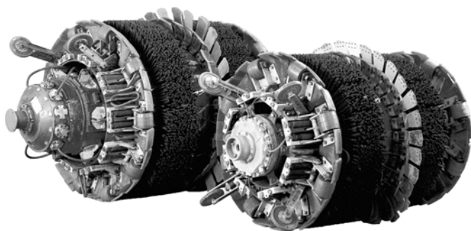
Рис. 2. Внутритрубные дефектоскопы, разработанные в НПО «Спектр»
