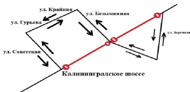
Рисунок 2 – Схема движения карьерного транспорта 1
