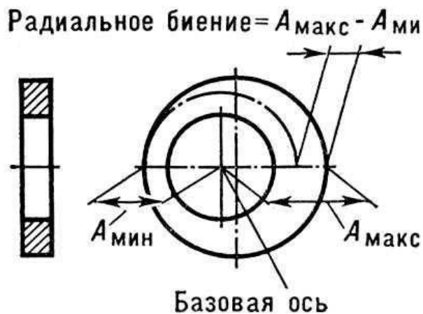
Рис. 7. Схема радиального биения.
