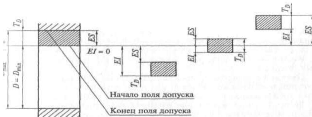
Рис. 1.4. Схема расположения полей допусков отверстий
