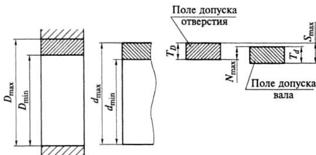
Рис.2.5 Схемы расположения полей допусков при переходных посадках
