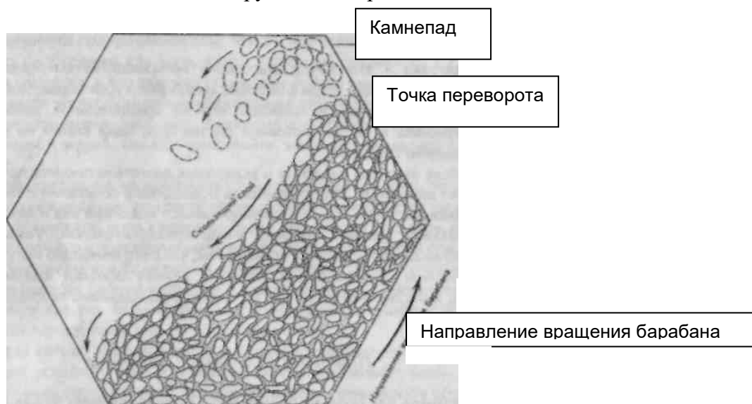
Рис.7. Поведение абразива в галтовочном барабане
