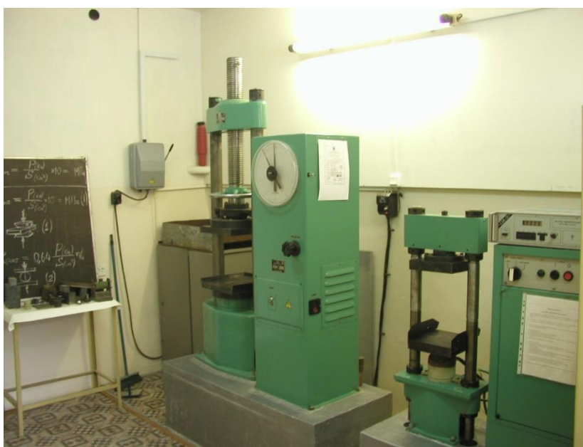
Рис. 1 Прессы в лаборатории физико-механических свойств горных пород
