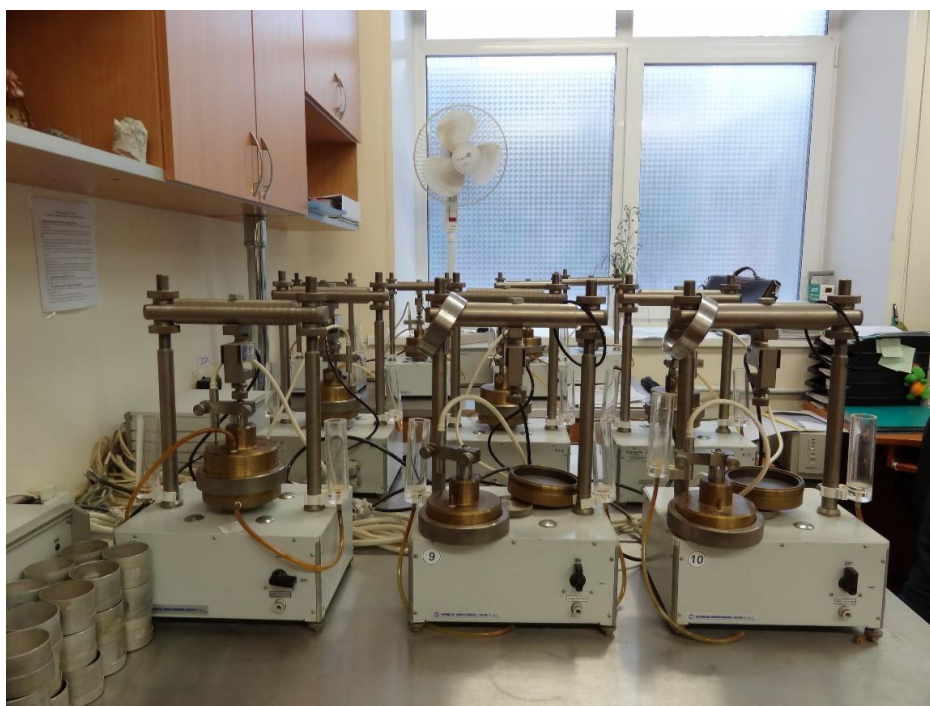
Рис. 1.5 Компрессионные приборы [8, с. 46]
