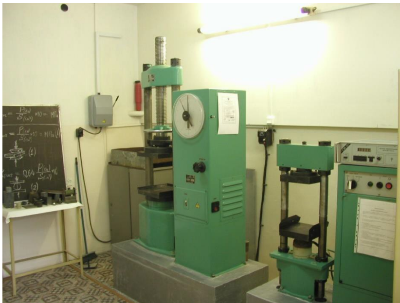
Рис. 1 Прессы в лаборатории физико-механических свойств горных пород
