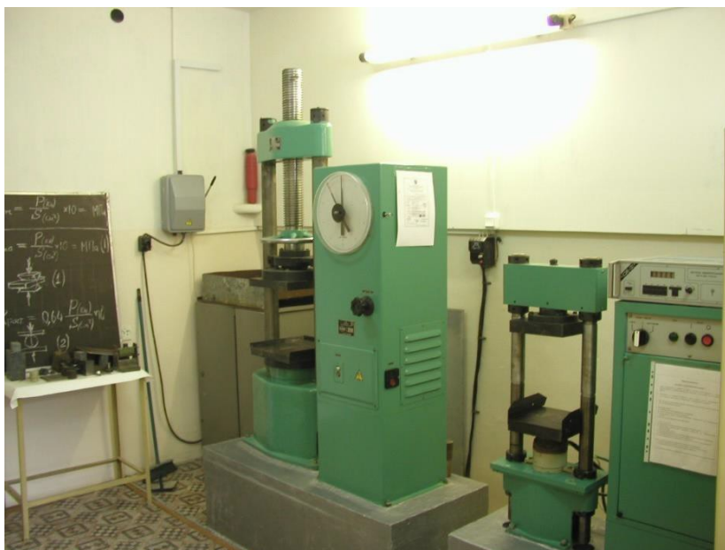
Рис. 1 Прессы в лаборатории физико-механических свойств горных пород
