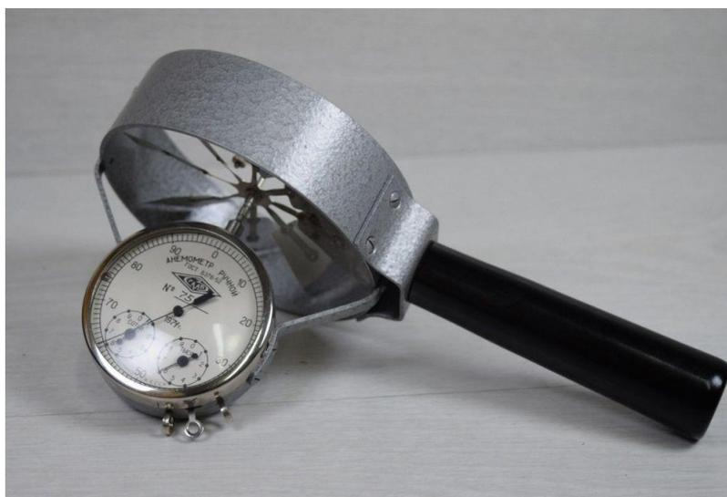
Рис 3.4 Чашечный анемометр
