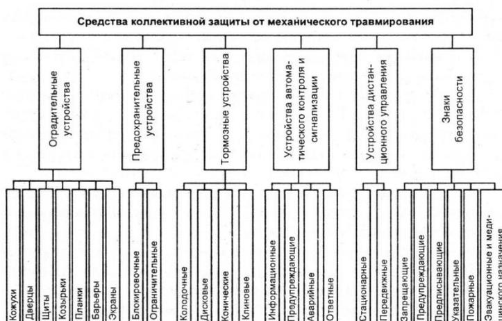
Рисунок 4.1 – Средства коллективной защиты от механического травмирования
