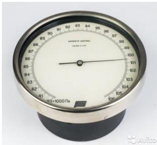
Рис. 3.1 Барометр-анероид «БААМ-1»
