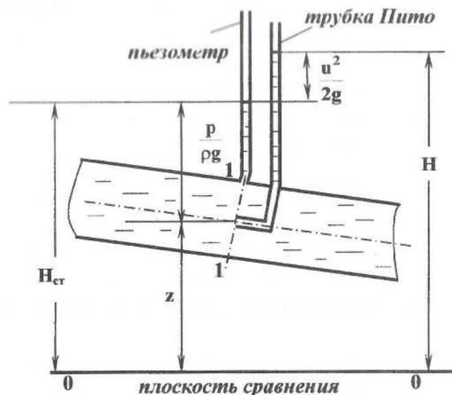
Рис.1.1. Экспериментальное определение статического, полного и скоростного напоров
