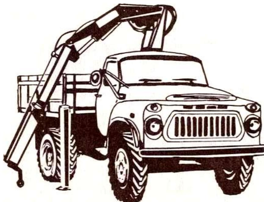
Рис. 20. Автомобиль-самопогрузчик со стреловым краном
