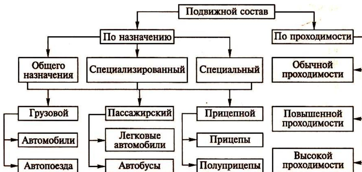
Рис. 8. Типы подвижного состава автомобильного транспорта
