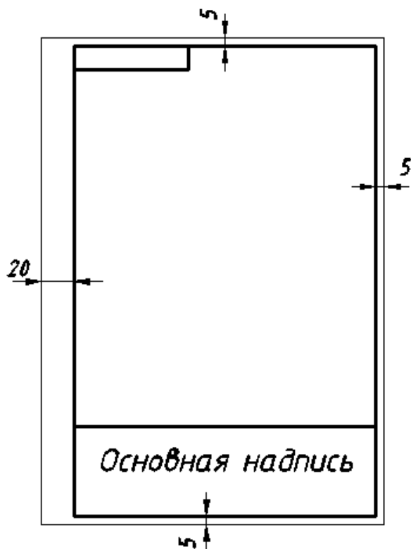
Рис. 3. Расположение основной надписи на формате А4
