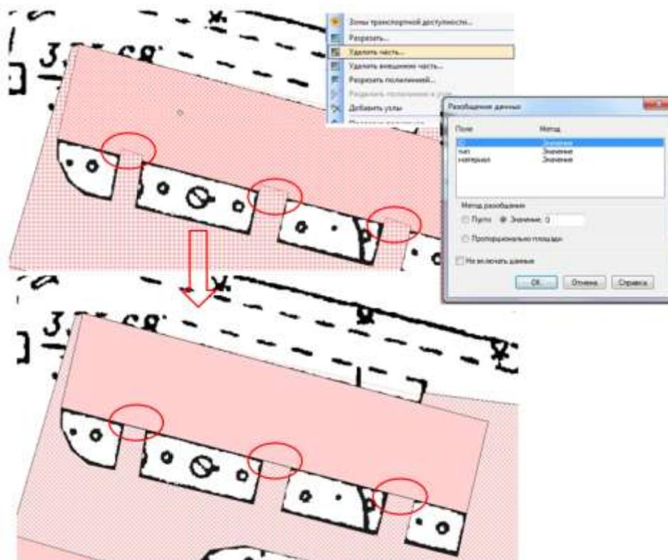
Рисунок 16 Пример выполнения привязки объекта слоя Замощение к слою Здания
