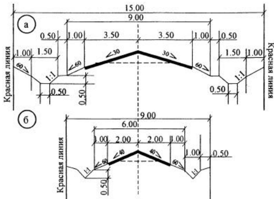
Рис. 2 Поперечные профили: а- улицы, б – проезда.<sup>3</sup>
