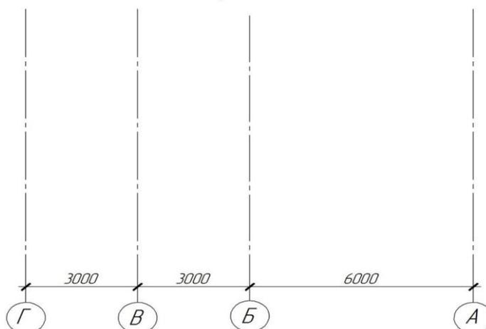
Рис. 10. Координационные оси здания, проходящие через несущие стены
