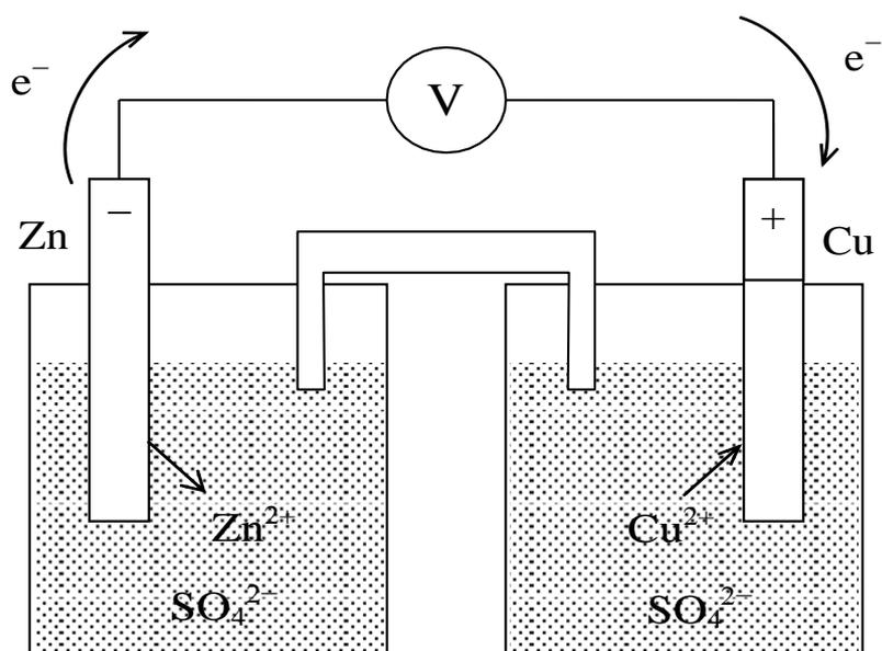
Рис. 10.1. Медно – цинковый гальванический элемент
