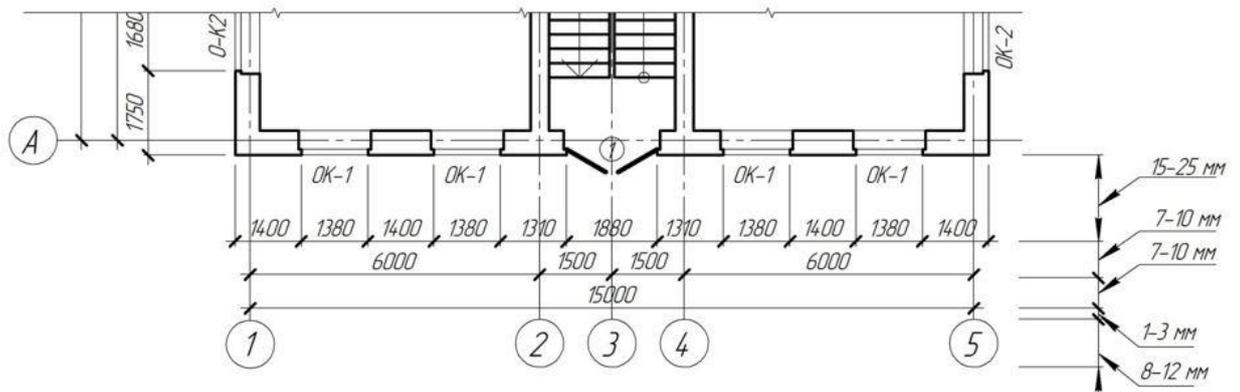
Рис. 8. Простановка наружных размеров
