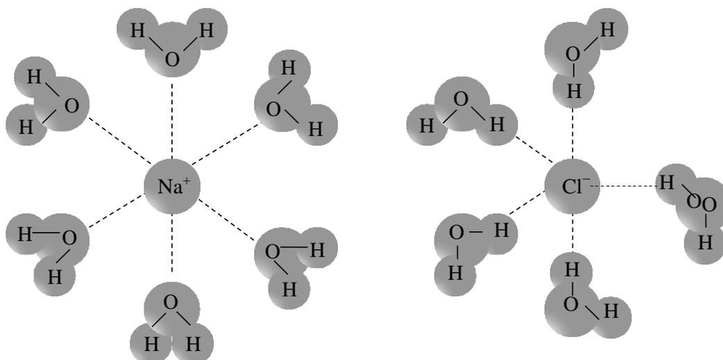
Рис. 6.2. Гидратированные ионы в растворе NaCl
