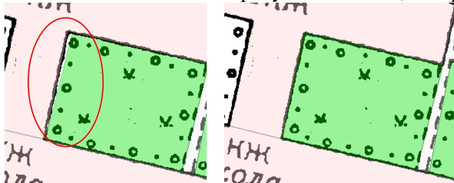
Рисунок 22 Пример некорректного (слева) и корректного(справа) примыкания полигонов
