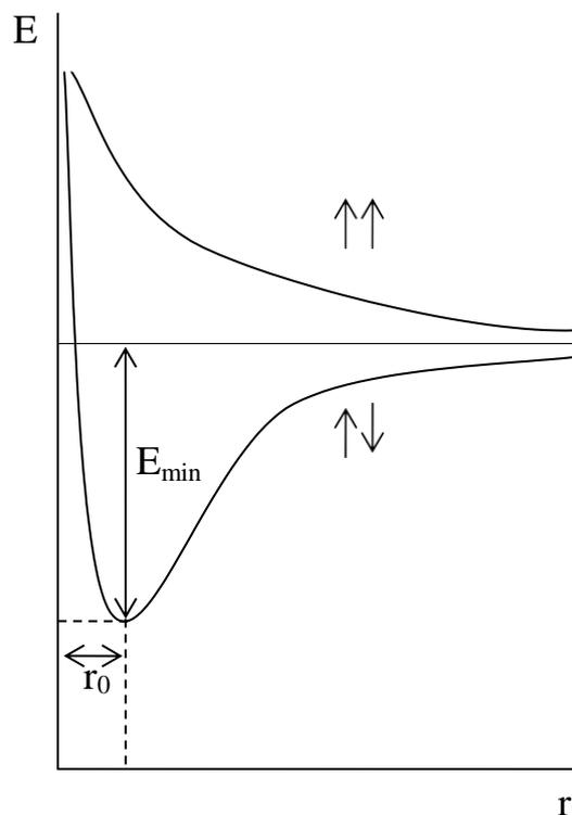
Рис. 9.2. Зависимость потенциальной энергии системы из двух атомов водорода от расстояния между ними
