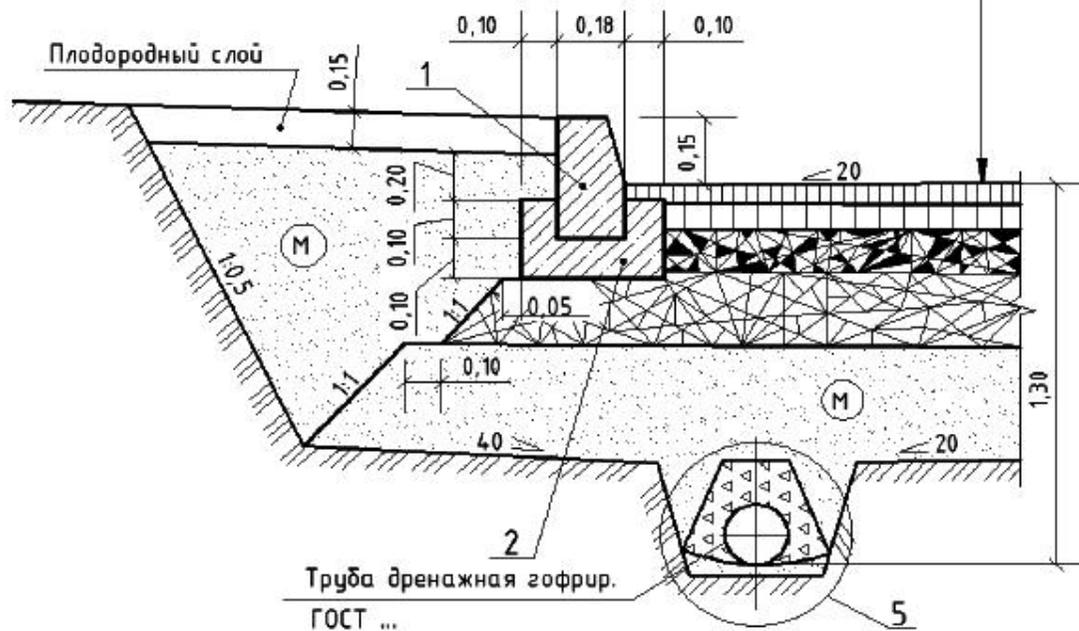
Рис.3. Пример оформления конструкции дорожной одежды
