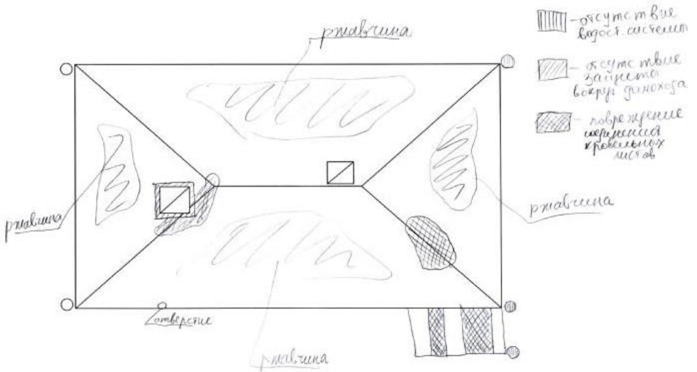
Рис.4. Дефектная карта кровли (здание рис.1,2).
