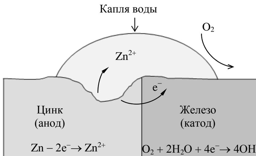
Рис. 10.4. Контакт металлического железа с цинком в присутствии воды
