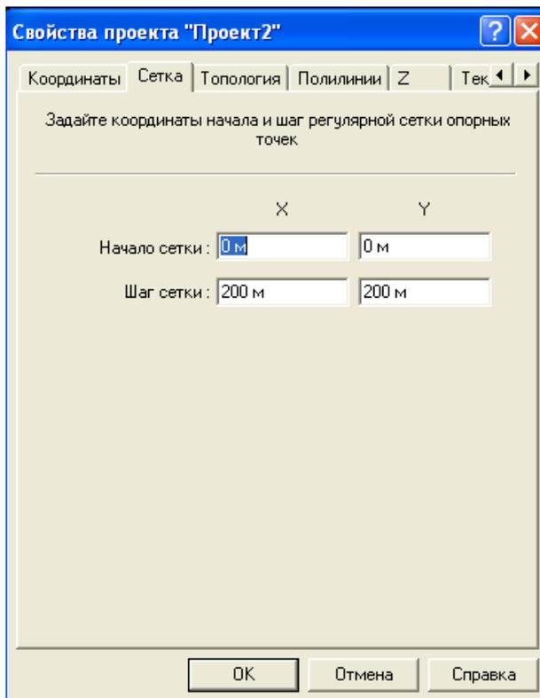
Рисунок 3 Пример заполнения закладки "Сетка"
