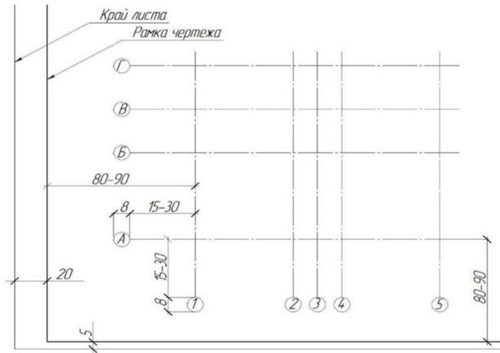
Рис.3. Нанесение координационной сетки
