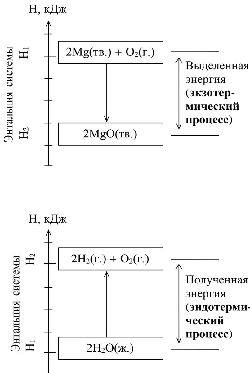
Рис. 2.1. Энергетическая схема теплового эффекта химической реакции
