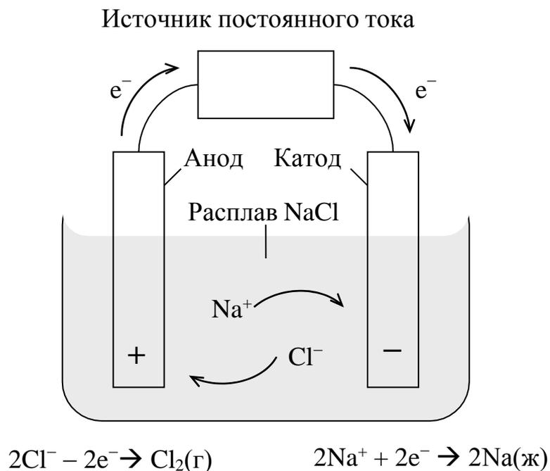
Рис. 10.3. Схема электролиза расплавленного NaCl
