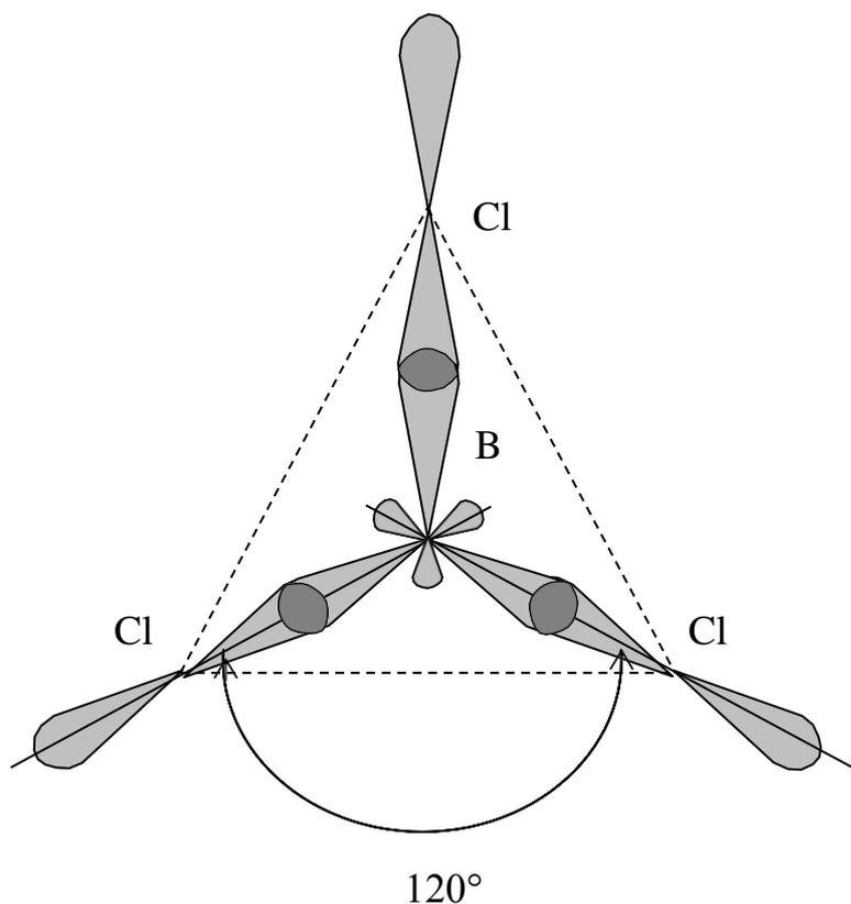
Рис. 9.7. Схема образования химических связей в молекуле  $\text{BCl}_3$
