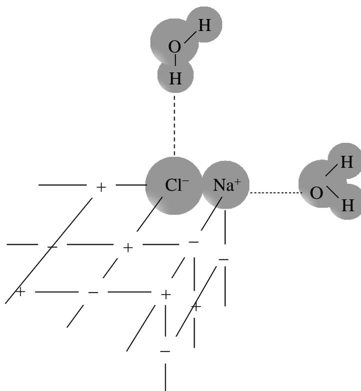
Рис. 6.1. Взаимодействие ионов NaCl с полярными молекулами H<sub>2</sub>O
