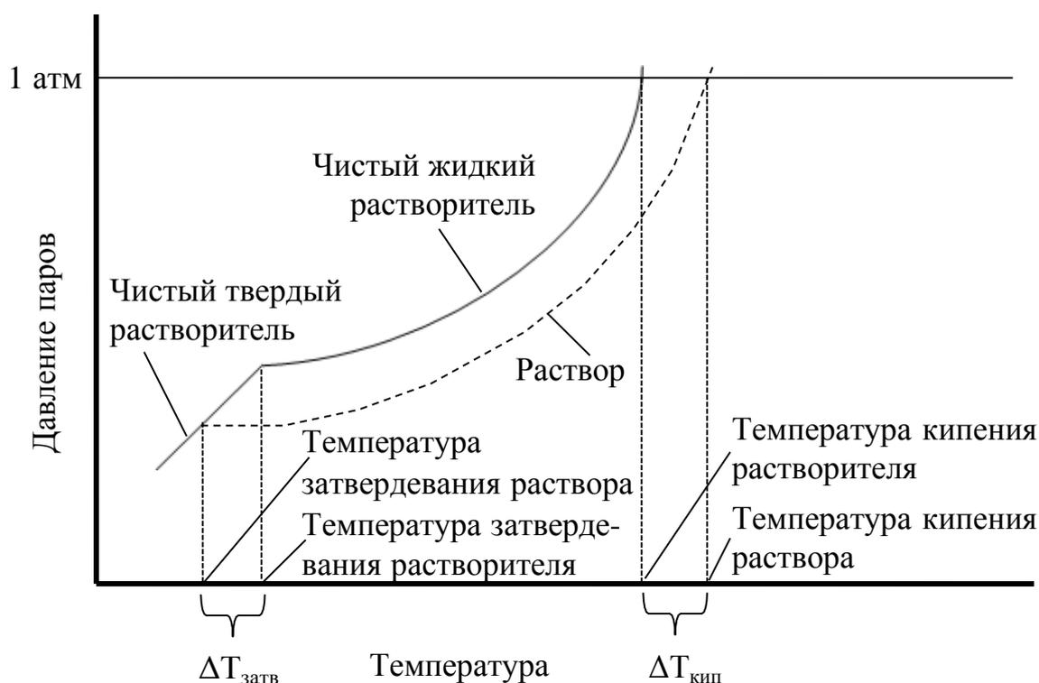
Рис. 5.1. Температурная зависимость парциального давления паров чистого растворителя и паров раствора нелетучего вещества при постоянном атмосферном давлении
