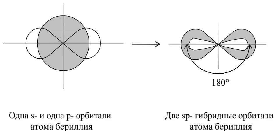
Рис. 9.5. Схема гибридизации  $s$ - и  $p$  - орбиталей атома бериллия
