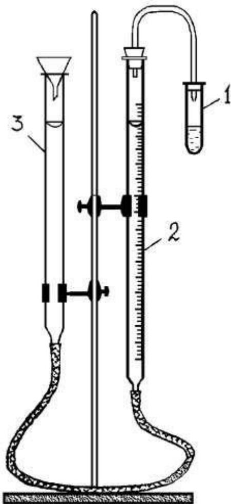
Прибор состоит из пробирки (1), бюретки (2) на 100 мл, заполненной водой или раствором хлорида натрия, стеклянной трубки и воронки (3), выполняющих роль уравнительного сосуда.
