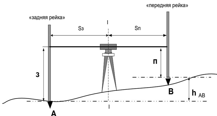
Рисунок 2 – Схема нивелирования «из середины»,.....<sup>1</sup>
