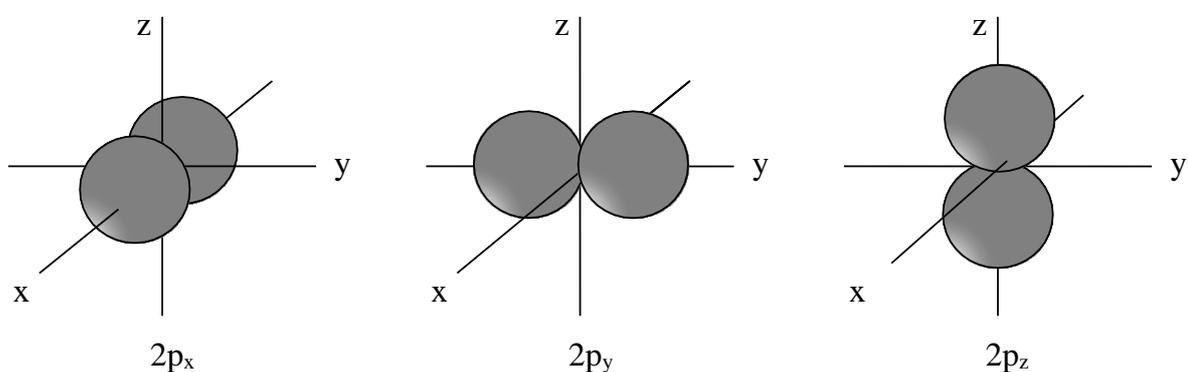
Рис. 8.2. Изображения контуров 2p – орбиталей. Три орбитали с различной ориентацией в пространстве соответствуют различным значениям магнитного квантового числа
