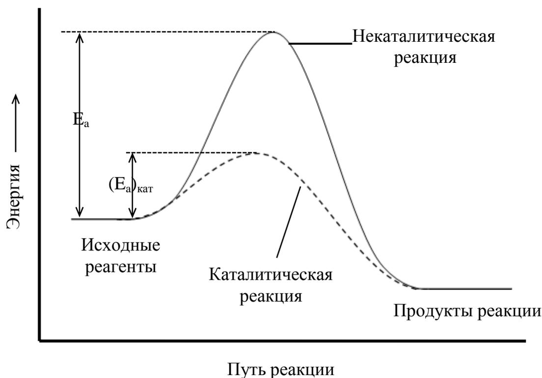
Рис. 3.2. Энергетическая диаграмма химической реакции с использованием катализатора. Действие катализатора заключается в снижении энергии активации реакции  $E_a$
