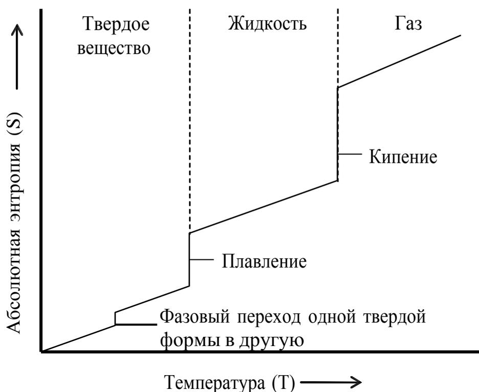
Рис. 2.2. Схема изменения энтропии при повышении температуры вещества
