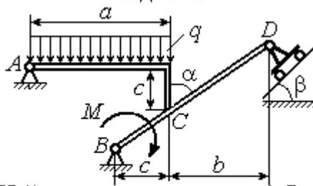
Найти реакцию шарниров  $A, B$  и  $D$  и реакцию опоры в точке  $C$
