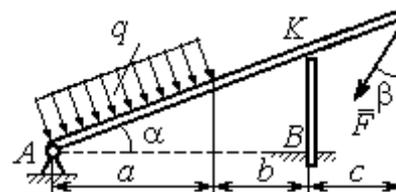
Найти реакцию шарнира  $A$ , реакцию опоры в точке  $K$  и реакцию жесткой заделки в точке  $B$
