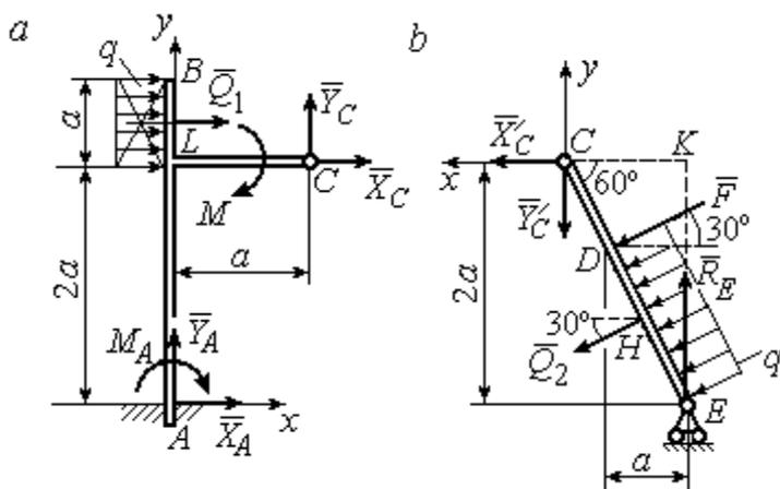
Рис. 1.10. Равновесие частей конструкции:
