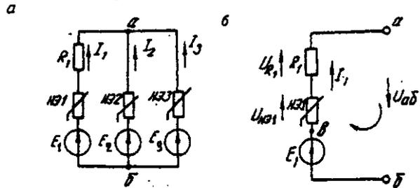
Рис. 6.2. Заданная (а) и расчетная (б) электрические схемы
