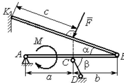
Найти реакции шарниров  $A, B$ , реакцию стержня  $CD$  и реакцию опоры в точке  $K$
