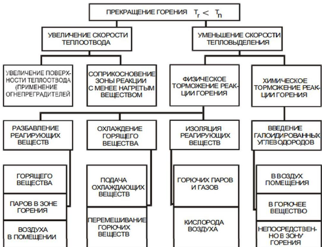
Рис. 2.1. Схема прекращения горения на пожарах
