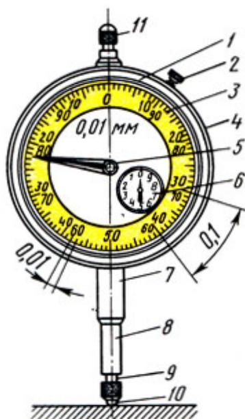
Рис. 18. Индикатор часового типа: 1 - корпус, 2 - стопор, 3 - циферблат, 4 - ободок, 5 - стрелка, 6 - указатель, 7 - гильза, 8 - измерительный стержень, 9 - наконечник, 10 - рабочий конец, 11 - головка
