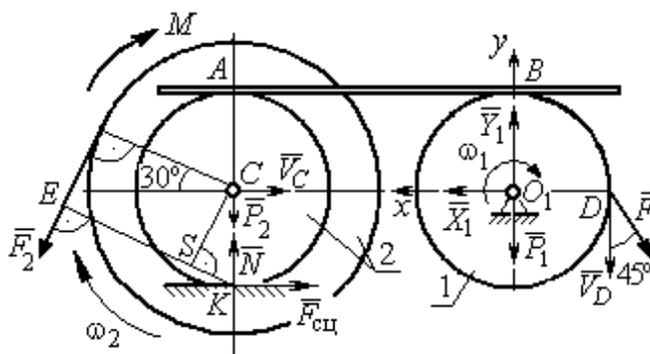
Рис. 3.8. Расчетная схема для исследования движения системы
