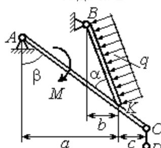
Найти реакцию шарниров  $A, B$ , реакцию стержня  $CD$  и реакцию опоры в точке  $K$
