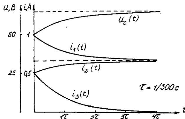
Рис. 5.5. Временные диаграммы токов и напряжения на емкости
