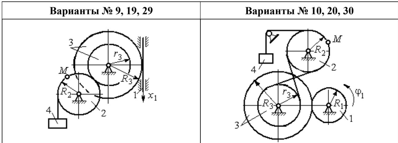
Рис. 2.4. Задание 2. Определение скоростей и ускорений точек при поступательном и вращательном движениях твёрдого тела.
