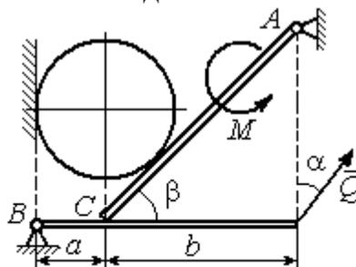
Вес шара  $P$ . Найти реакцию шарниров  $A, B$ , давление шара на балку и стенку, реакцию опоры балки в точке  $C$  и уравновешивающую силу  $Q$
