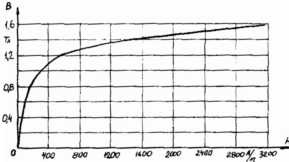
Рис. 7.4. Кривая намагничивания
