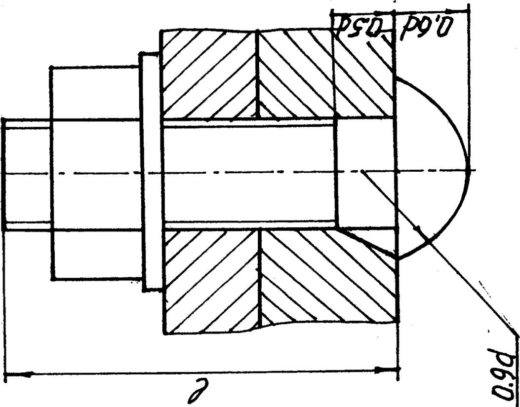
Рис. 5. Определение размеров упрощенного изображения болтового соединения
