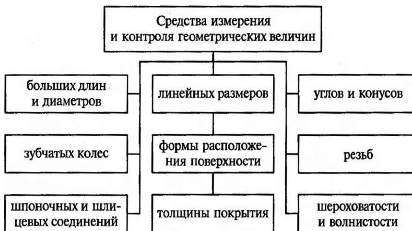
Рис. 2. Классификация средств измерения и контроля по виду измеряемых
