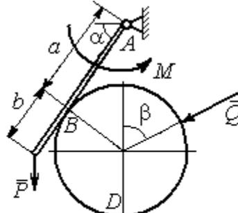
Найти реакцию шарнира  $A$ , давление балки на шар, реакцию опоры шара в точке  $D$  и уравновешивающую силу  $Q$
