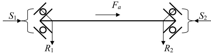
**Рис. 3.1. Схема вала на радиально-упорных подшипниках:**
