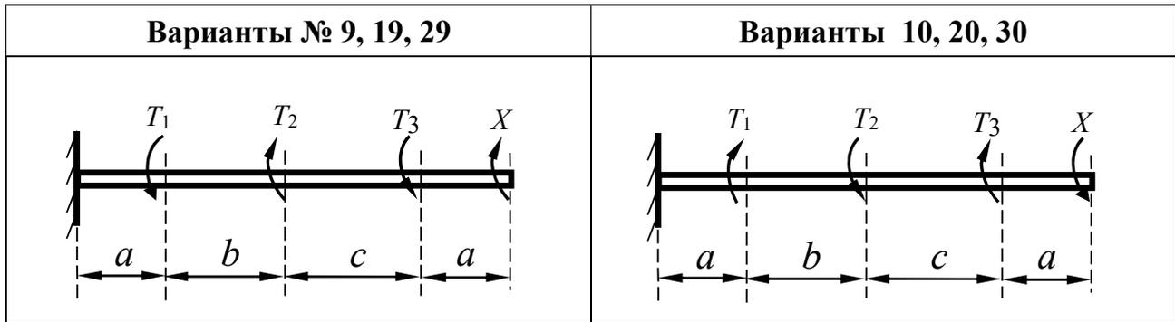
Рис. 4.6. Задание 7. Деформация кручения статически неопределимого вала.
