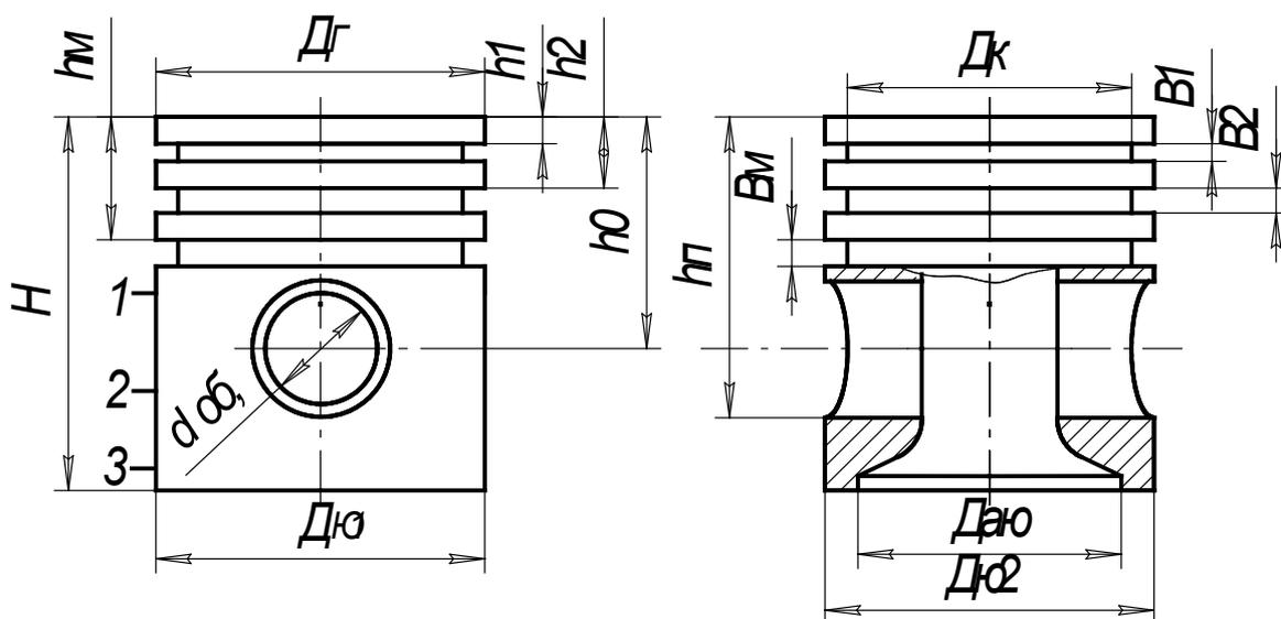
Рис.4. Чертеж поршня
