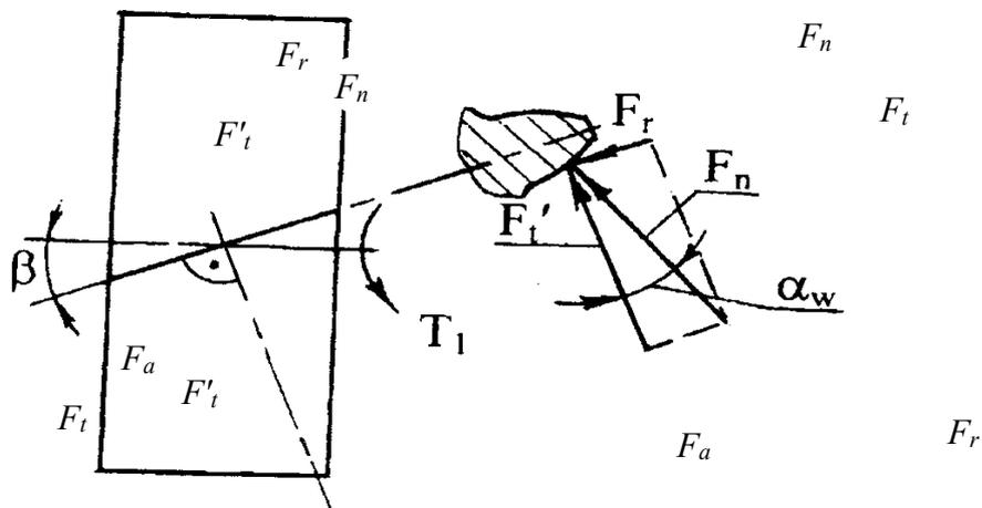
Рис. 2.7. Силы, действующие на зуб косозубого колеса
