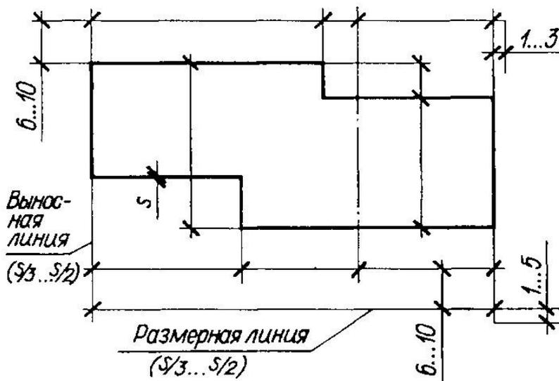
Рисунок 5 - Нанесение размерных и выносных линий.
