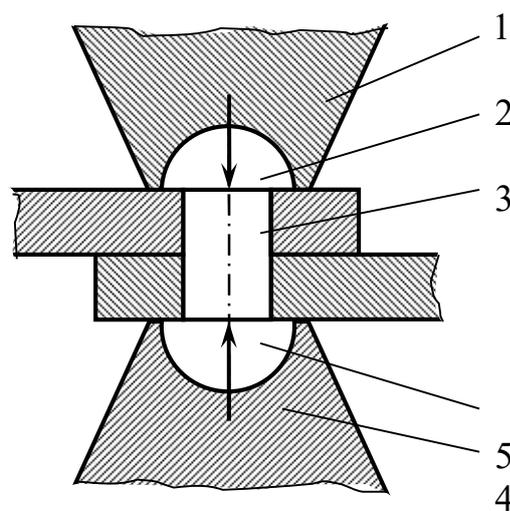
Рис. 1.8. Заклепочное соединение
