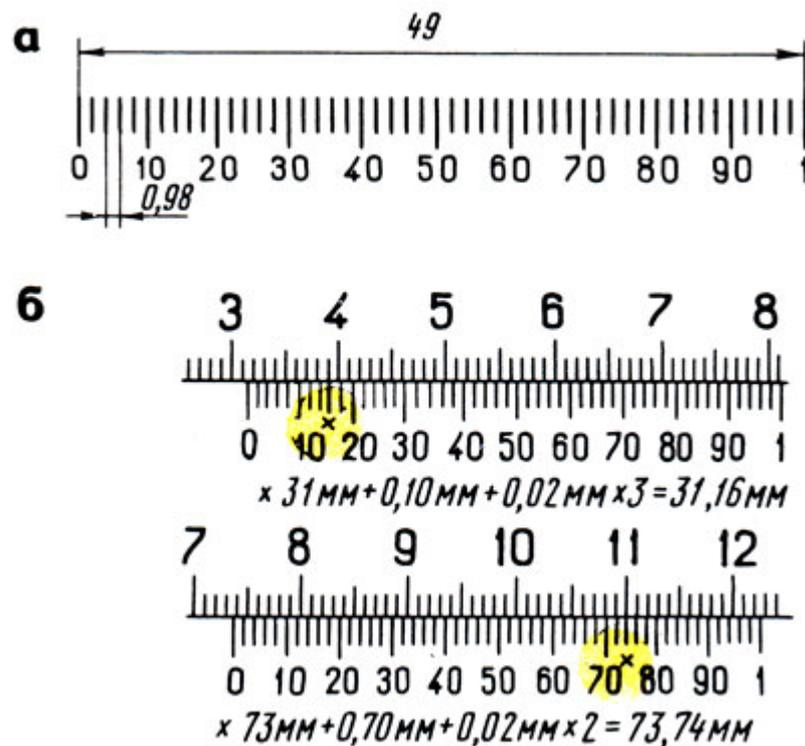
Рис. 8. Нониус штангенциркуля с величиной отсчета 0,02 мм (а), примеры отсчета (б)
