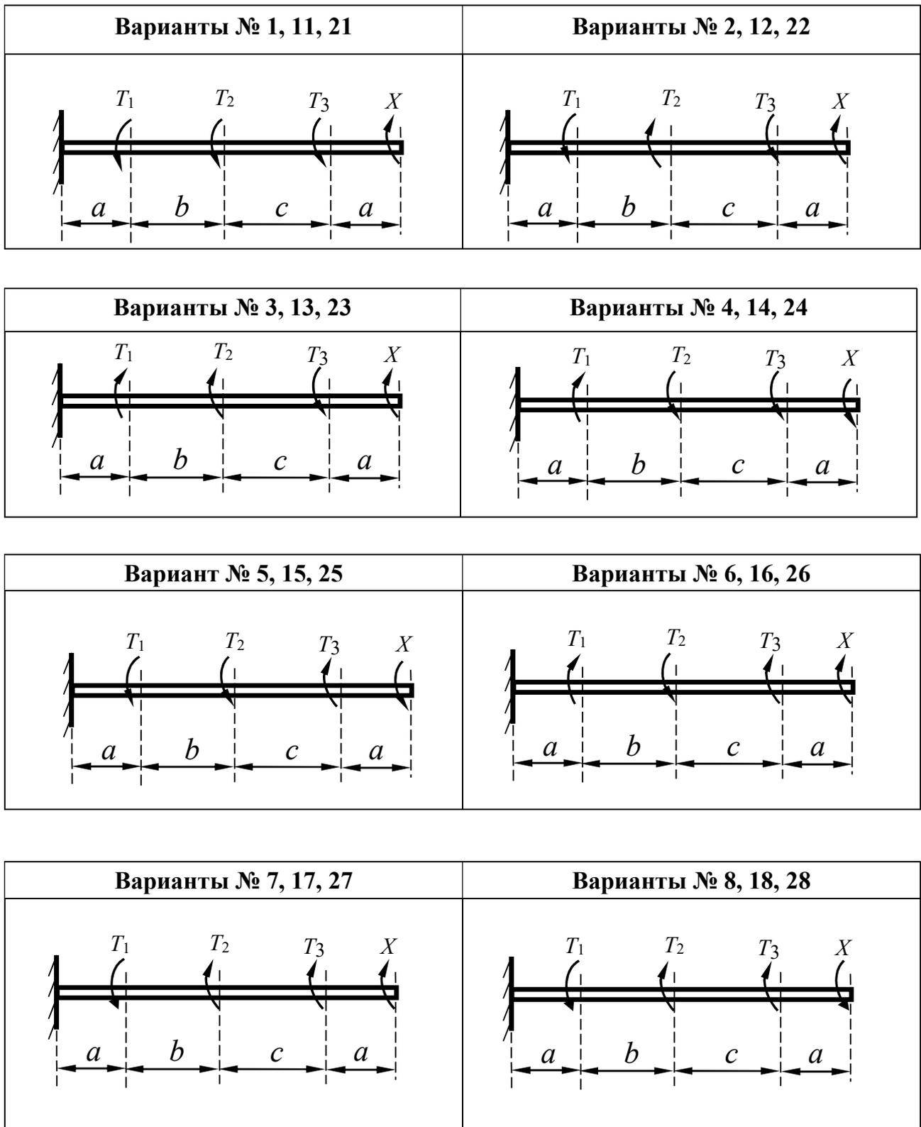
Рис. 4.5. Задание 7. Деформация кручения статически неопределимого вала.
