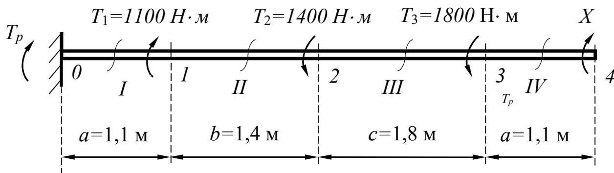
Рис. 4.7. Стальной вал
