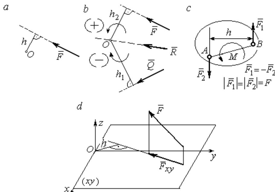
Рис. 1.2. Схемы для вычисления моментов сил:
