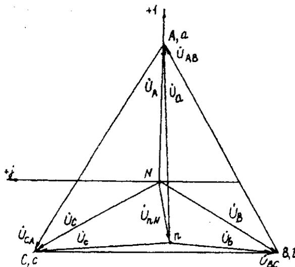
Рис. 3.3. Векторная диаграмма напряжений генератора и нагрузки
