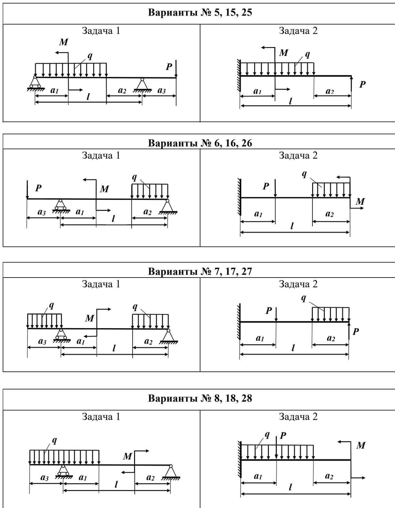
Рис. 4.12. Задание 8. Проверка балки на прочность.
