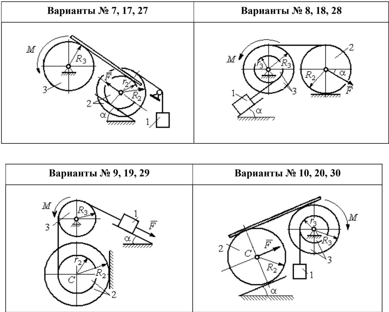
Рис. 3.2. Задание 4. Динамический расчёт механической системы.
