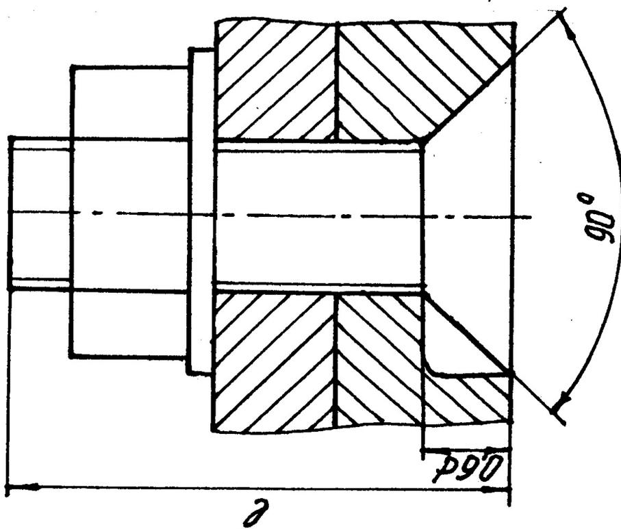
Рис. 4. Определение размеров упрощенного изображения болтового соединения
