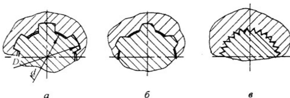
**Рис. 1.2. Разновидности шлицевых соединений по форме профиля зуба**
