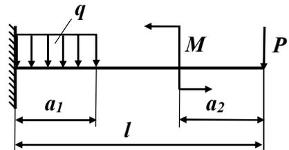
Рис. 4.11. Задание 8. Проверка балки на прочность.
