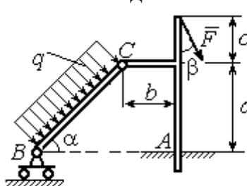
Найти реакцию жесткой заделки в точке  $A$  и реакции шарниров  $B$  и  $C$
