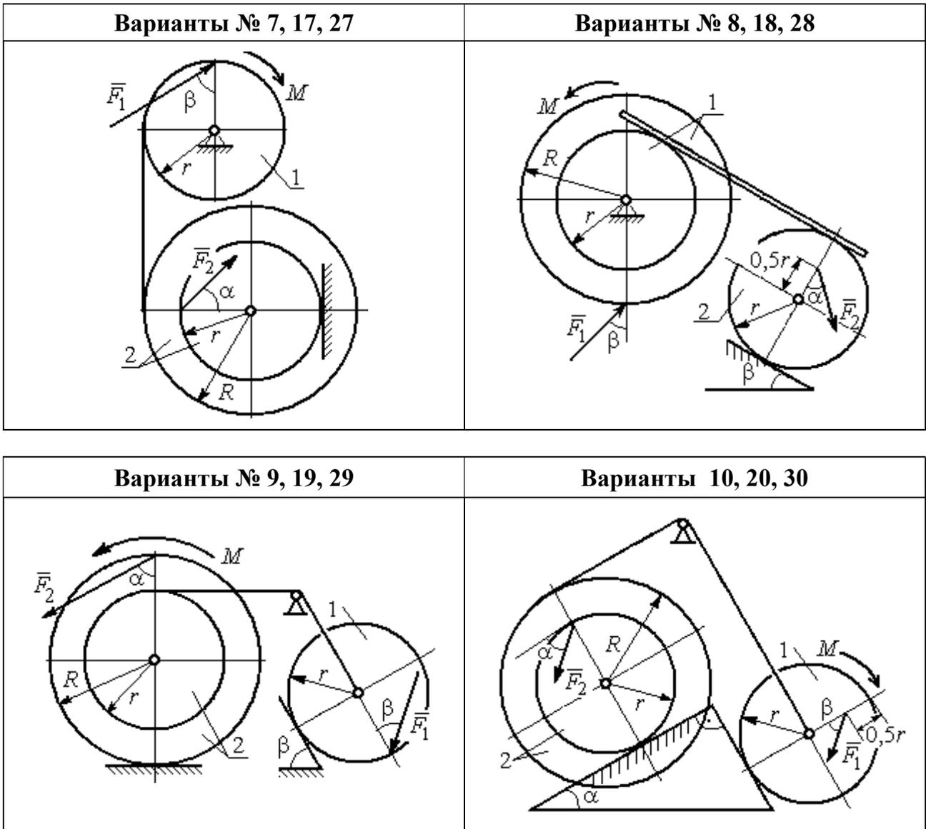
Рис. 3.6. Задание 5. Исследование движения механической системы с применением теоремы об изменении кинетической энергии.
