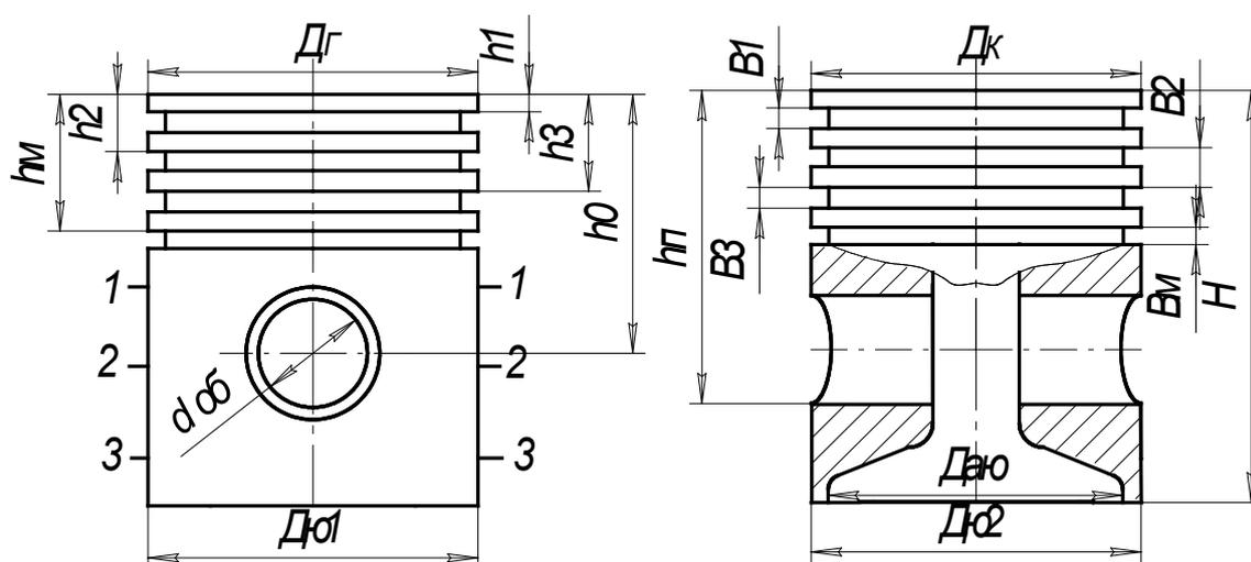
Рис.5. Чертеж поршня
