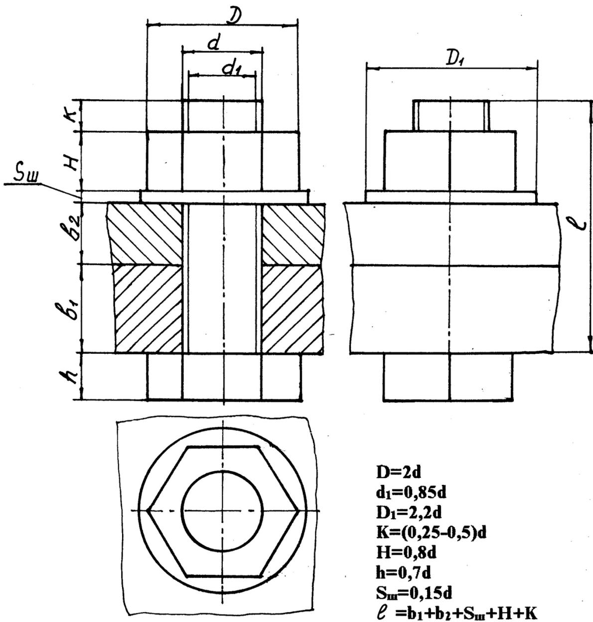
Рис. 3. Определение размеров упрощенного изображения болтового соединения
