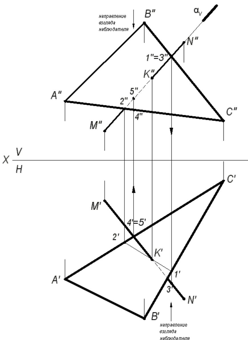
Рис. 2. Построение точки пересечения прямой с плоскостью
