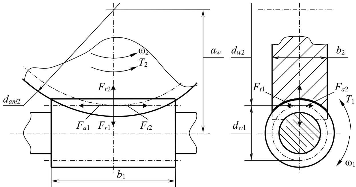
Рис. 2.10. Схема червячной передачи с цилиндрическим червяком
