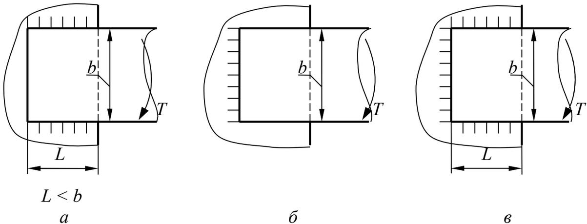
**Рис. 1. 17. Соединения, нагруженные парой сил с моментом  $T$**
