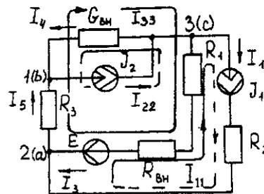
Рис. 1.3. Схема электрической цепи для метода контурных токов
