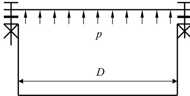
**Рис. 1.6. Соединение «болт затянут, внешняя нагрузка раскрывает стык»**
