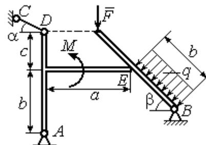
Найти реакции шарниров  $A, B$ , реакцию опоры в точке  $E$  и реакцию стержня  $CD$
