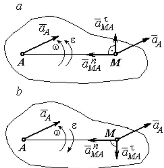
Рис. 2.2. Ускорение точки плоской фигуры:
