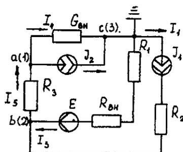
Рис. 1.4. Схема электрической цепи для метода узловых потенциалов
