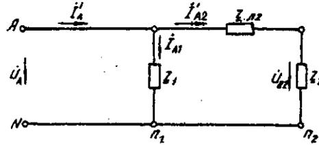
Рис. 4.3. Расчетная схема токов в фазе А
