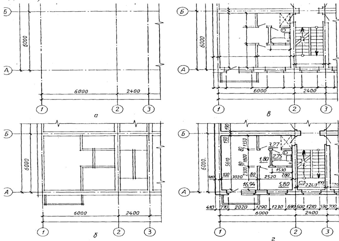
Рисунок 6 - Последовательность вычерчивания плана здания
