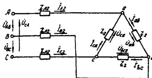
Рис. 4.2. Треугольник сопротивлений второго приемника
