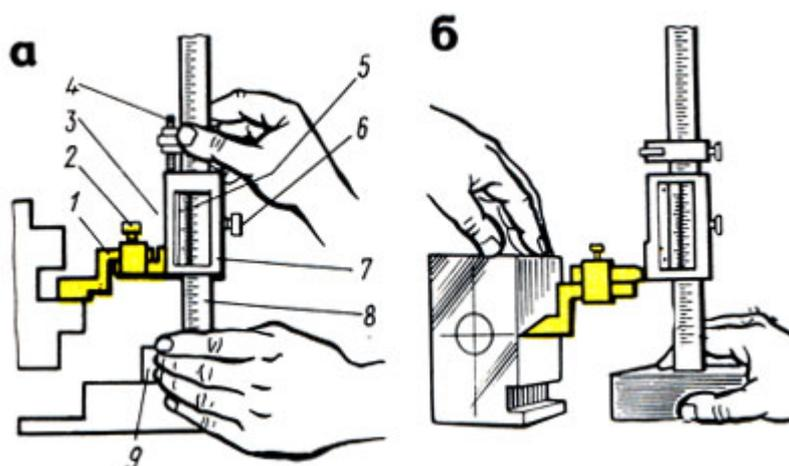
Рис. 10. Штангенрейсмас: а - прием измерения, б - прием разметки; 1 - сменные ножки для измерения, 2, 6 - стопорные винты, 3 - державка, 4 - микроподача, 5 - нониус, 7 - рамка, 8 - штанга, 9 - основание
