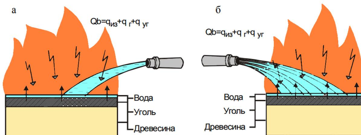
Воздействие воды на горение древесины:
