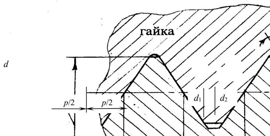
Рис. 1.3. Основные геометрические параметры треугольной резьбы
