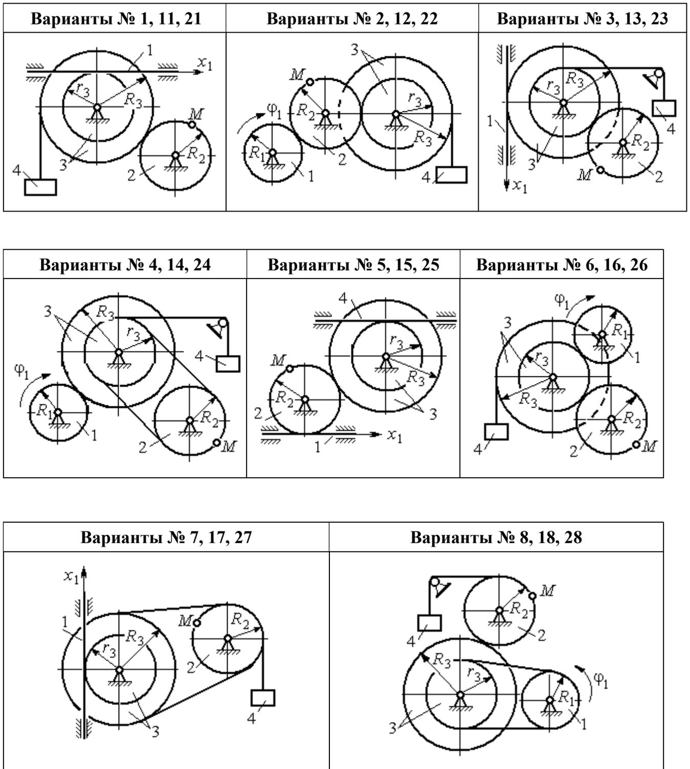
Рис. 2.3. Задание 2. Определение скоростей и ускорений точек при поступательном и вращательном движениях твёрдого тела.
