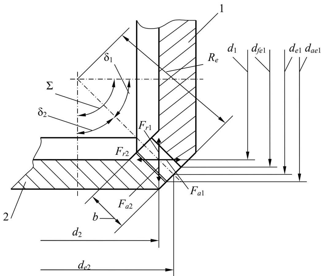
Рис. 2.8. Основные геометрические параметры конической зубчатой передачи
