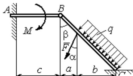
Найти реакцию жесткой заделки в точке  $A$ , реакцию шарнира  $B$  и реакцию опоры в точке  $C$
