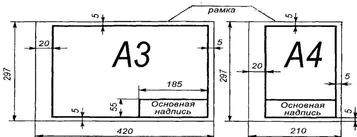
Рисунок 3 - Примеры размеров сторон форматов А4 и А3.
