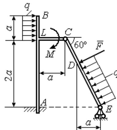
Рис. 1.9. Равновесие конструкции двух балок, соединённых шарниром
