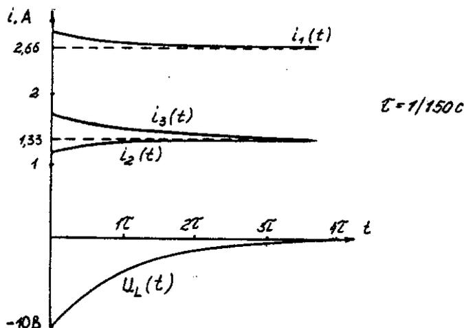
Рис. 5.3. Временные диаграммы токов и напряжения на индуктивности
