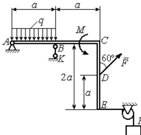
Рис. 1.7. Конструкция рамы
