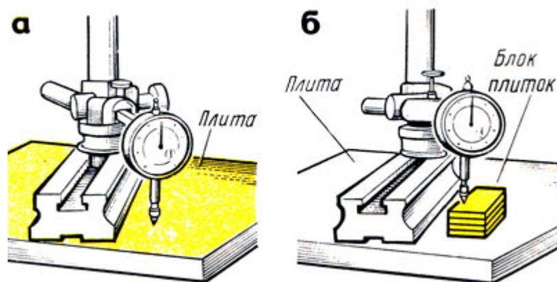
Рис. 20. Установка индикатора в начальное положение: а - соприкосновением с поверхностью стола (плиты), б - с поверхностью установочной меры
