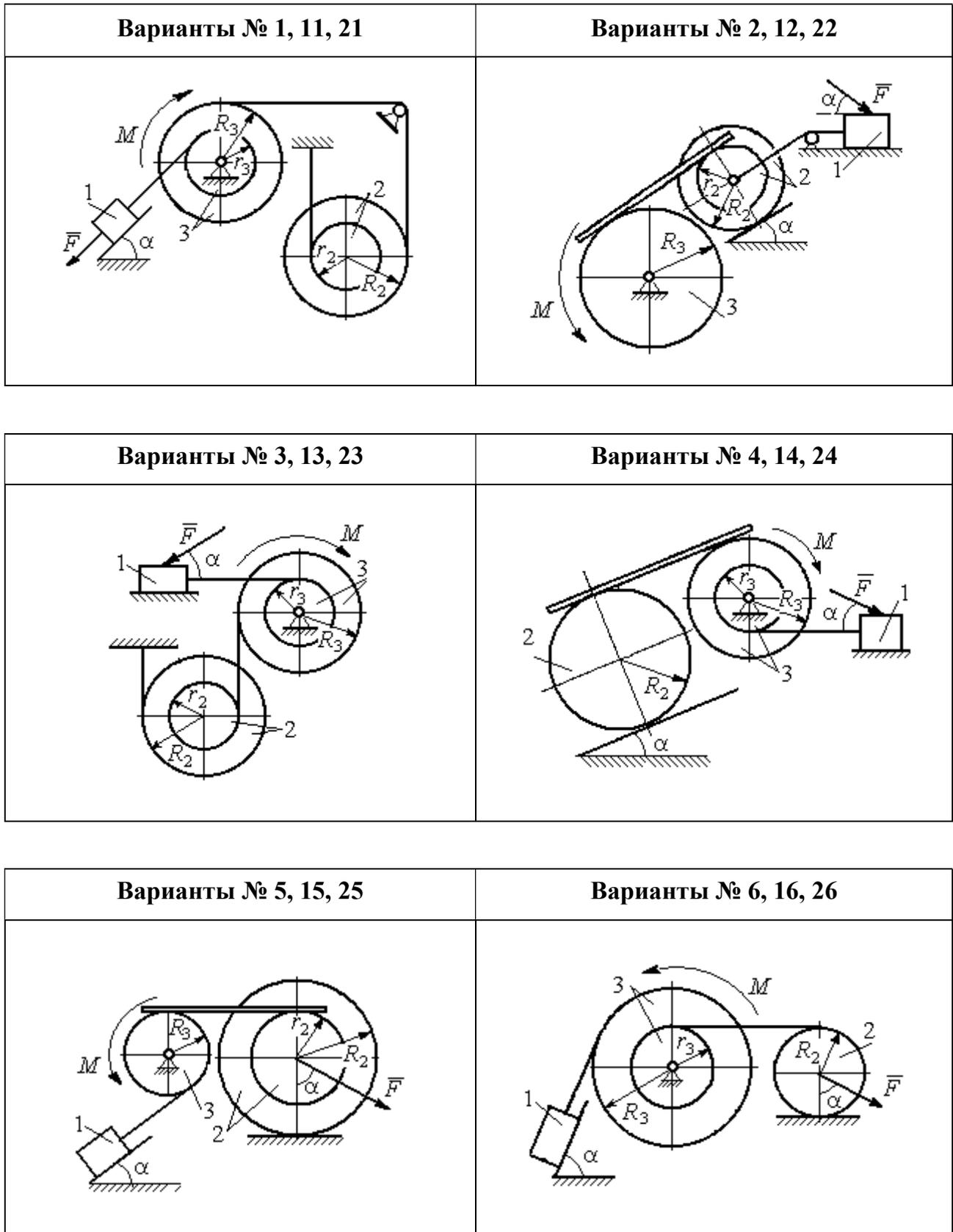
Рис. 3.1. Задание 4. Динамический расчёт механической системы.
