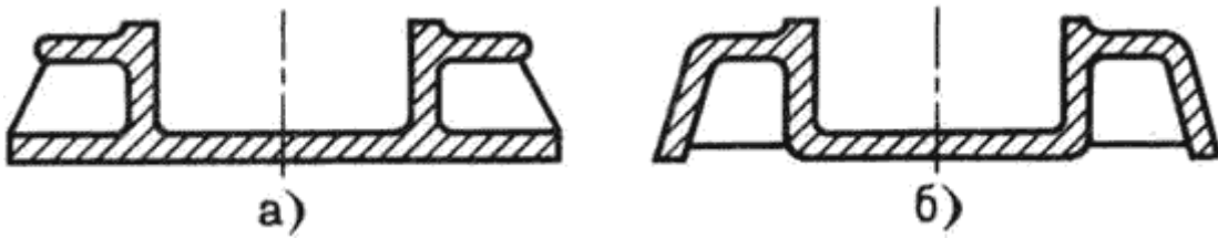
Рис.8.9. Устранение пазов в конструкции литой детали
