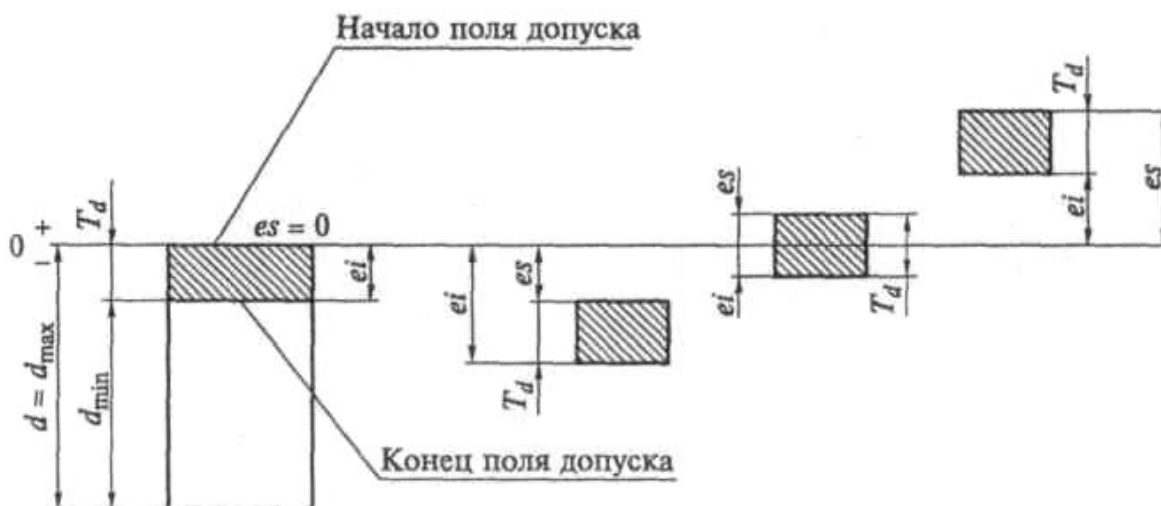
Рис. 1.5. Схема расположения полей допусков валов
