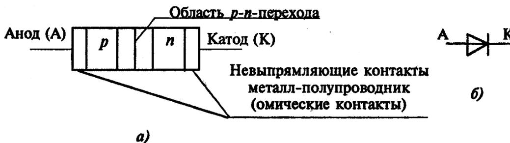
Рис. 2.2. Схема структуры полупроводникового диода (а) и его графическое обозначение (б)
