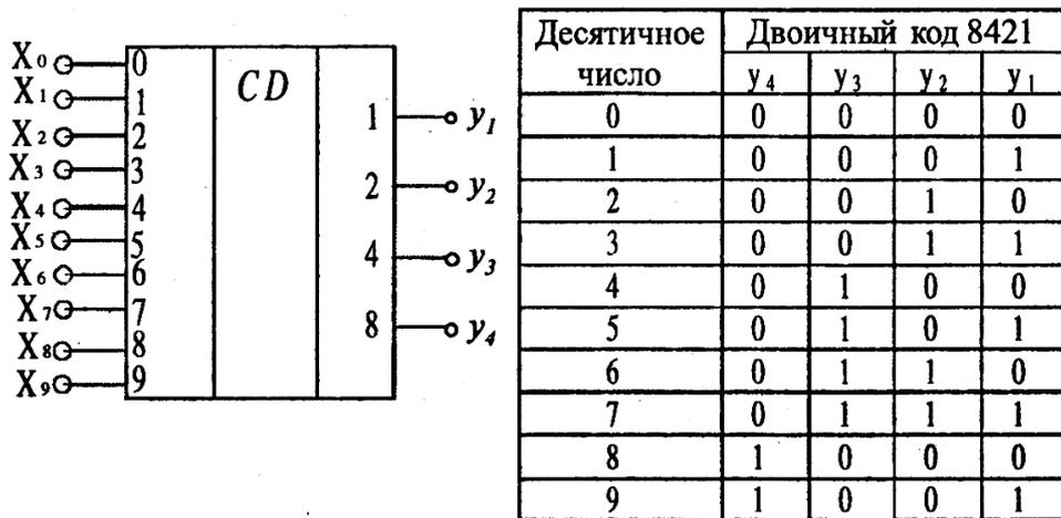
Рис. 16.1. Схема шифратора и таблица соответствия кода
