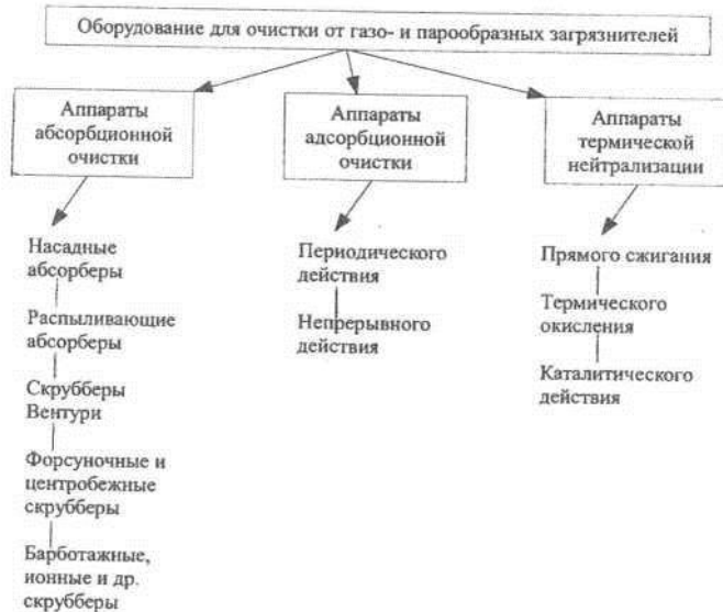
Рис. 5.14. Классификация оборудования для очистки от газо- и парообразных загрязнителей
