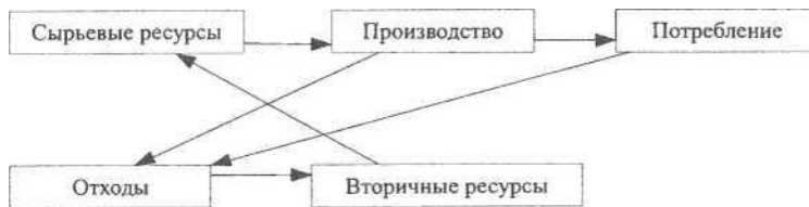
Рис. 3.1. Принцип функционирования малоотходной и безотходной технологии
