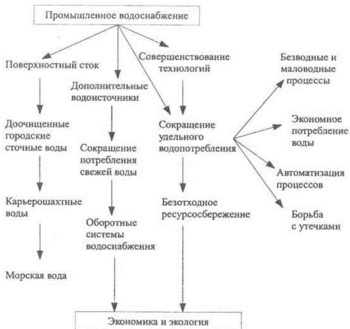
Рис. 5.16. Схема промышленного водопользования
