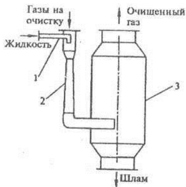
Рис. 5.7. Скруббер Вентури: 1 — орошающая форсунка; 2 — труба Вентури; 3 — каплеуловитель
