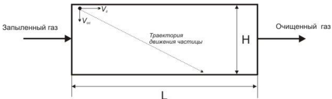
Рисунок 2. К расчету пылеосадительной камеры.
