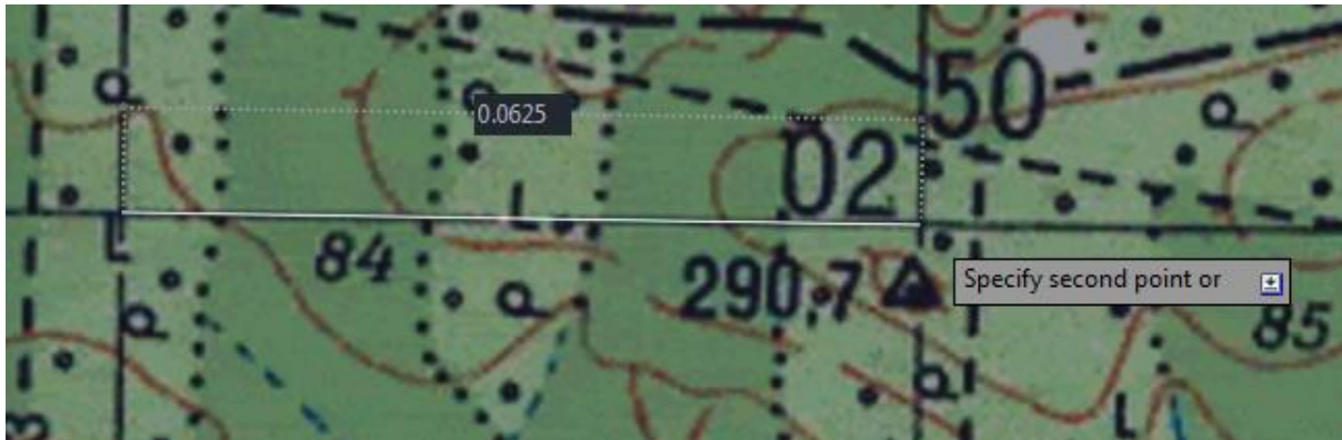
Рисунок 6 – Измерение расстояния между крестами километровой сетки.
