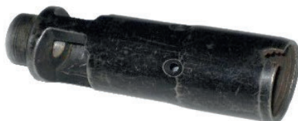
Рис. 12.23. Дульный тормоз – компенсатор
