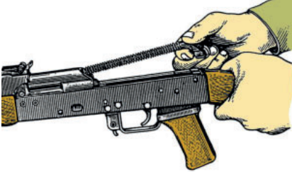
Рис. 12.37. Отделение возвратного механизма
