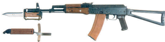
Рис. 12.3. Автомат Калашникова со складывающимся прикладом (АКС-74)
