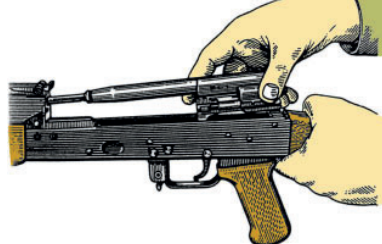
Рис. 12.38. Отделение затворной рамы с затвором
