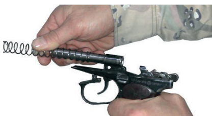
Рис. 11.16. Присоединение возвратной пружины
