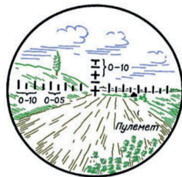
Рис. 15.7. Измерение угла при помощи бинокля
