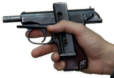
Рис. 11.12. Проверка отсутствия патрона
