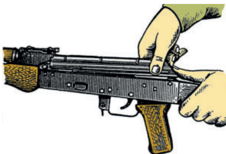
Рис. 12.36. Отделение крышки ствольной коробки
