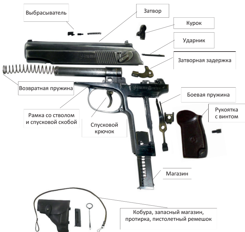
Рис. 11.1. Части, механизмы и принадлежность 9-мм пистолета Макарова
