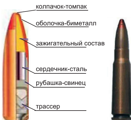
Рис. 14.7. Зажигательная пуля
