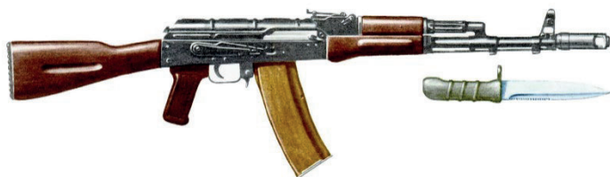
Рис. 12.2. Автомат Калашникова (АК-74) с обычным прикладом
