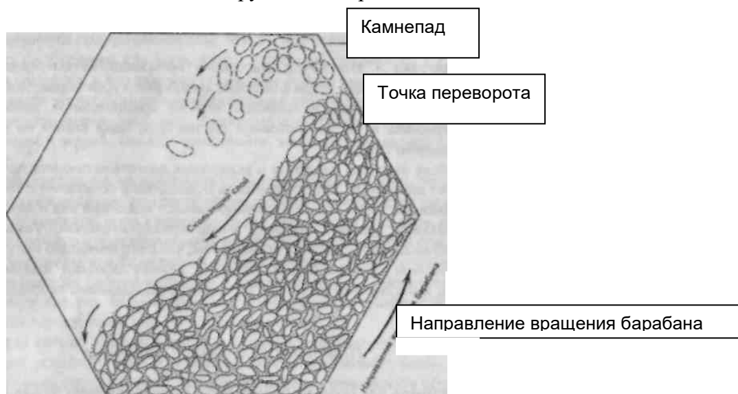
Рис.7. Поведение абразива в галтовочном барабане
