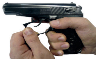
Рис. 11.13. Оттягивание спусковой скобы
