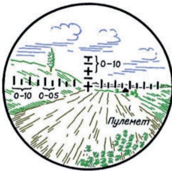
Рис. 15.7. Измерение угла при помощи бинокля
