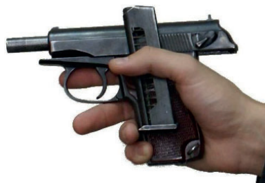
Рис. 11.12. Проверка отсутствия патрона
