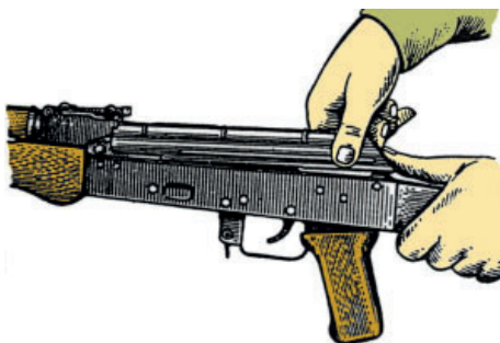
Рис. 12.36. Отделение крышки ствольной коробки
