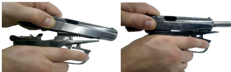
Рис. 11.17. Присоединение затвора к рамке
