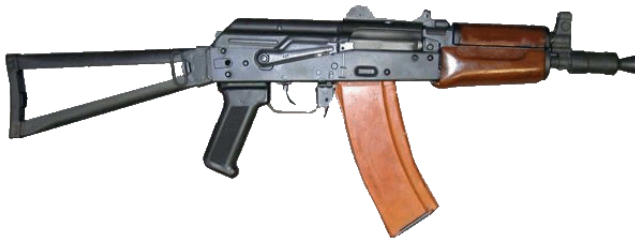
Рис. 12.6. Автомат Калашникова со складывающимся прикладом и укороченным стволом (АКС-74У)
