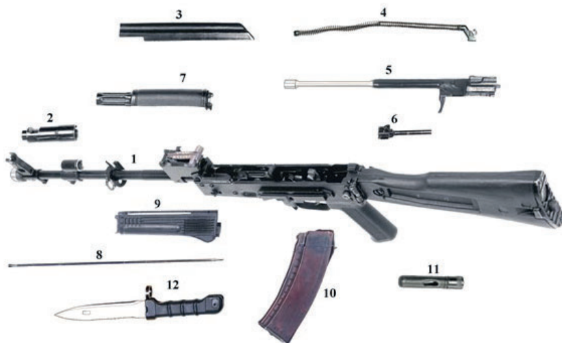
Рис. 12.8. Основные части и механизмы автомата:
