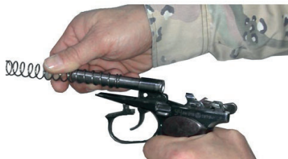
Рис. 11.15. Снятие возвратной пружины
