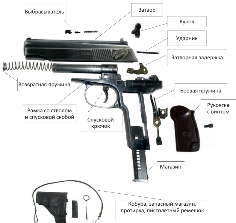
Рис. 11.1. Части, механизмы и принадлежность 9-мм пистолета Макарова
