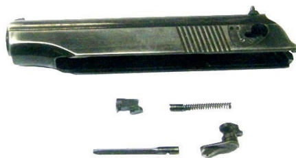
Рис. 11.3. Затвор с ударником, выбрасывателем и предохранителем
