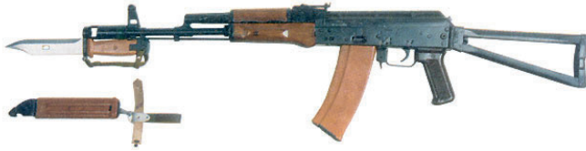
Рис. 12.3. Автомат Калашникова со складывающимся прикладом (АКС-74)
