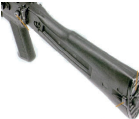
Рис. 12.14. Приклад и пистолетная рукоятка
