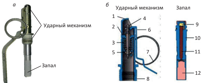
Рис. 13.4. Запал гранаты УЗРГМ: а – общий вид; б – в разрезе;
