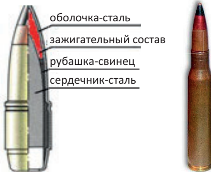
Рис. 14.10. Бронебойно-зажигательная пуля
