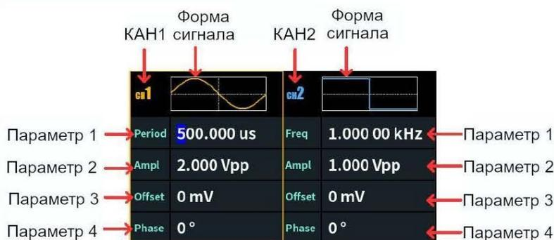
Экран прибора в режиме отображения параметров двух каналов
