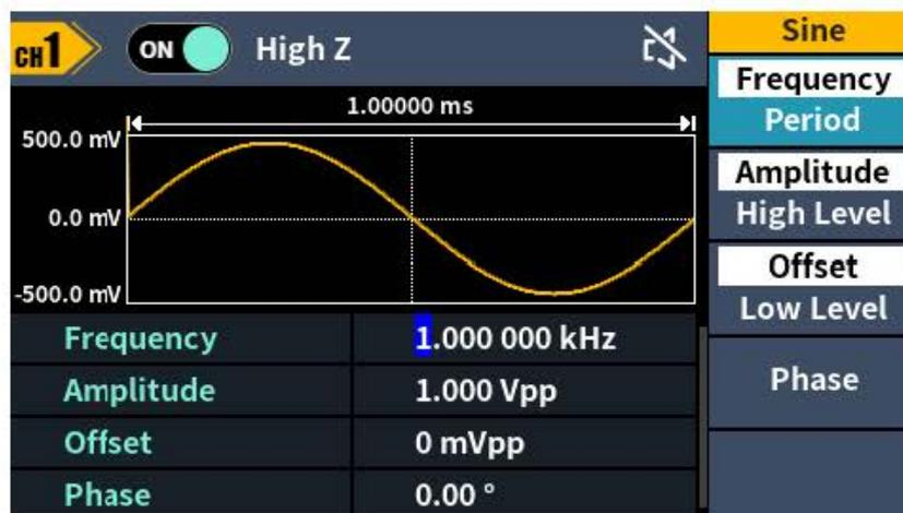
Режим формирования сигнала синусоидальной формы
