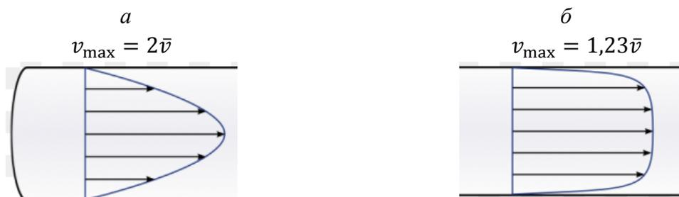
Рис. 13.1. Движение газов (жидкостей) в тонкой трубке:
