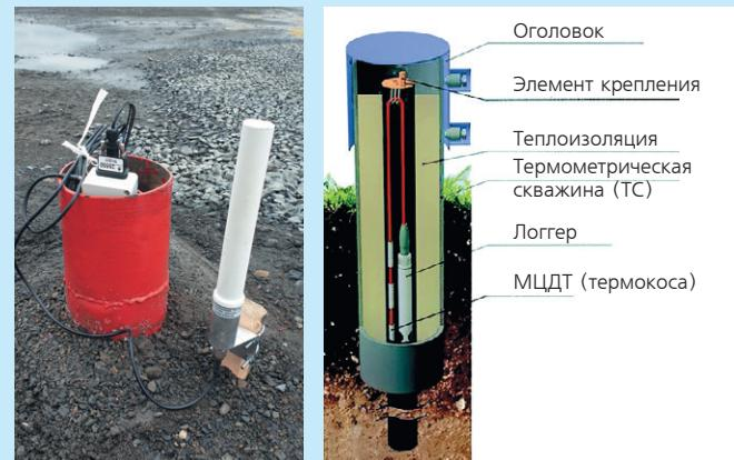
том всех показателей выполняем теплотехнический расчет, по результатам которого получаем распределение температуры грунтов по глубине, площади и времени.
