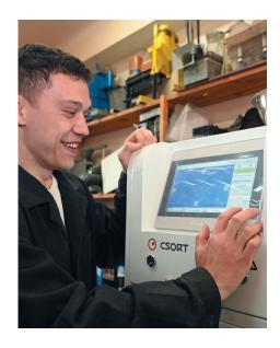
Влаборатории кафедры обога-щения полезных ископаемых УГГУ запустили новое оборудование — фотометрический сепаратор «MiniSort», созданный российской компанией «CSort». Устройство позволяет разделять породу по цвету за счет двух встроенных камер.
