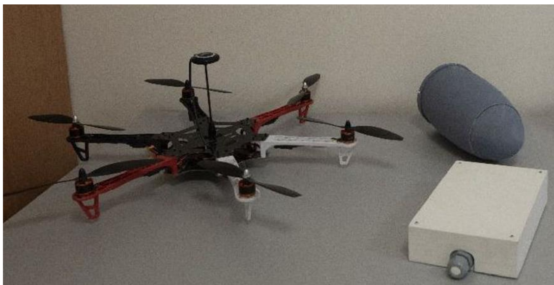
Рис. 1 – Фотография прототборника воды и комбо-системы, используемых в динамике при помощи БПЛА
