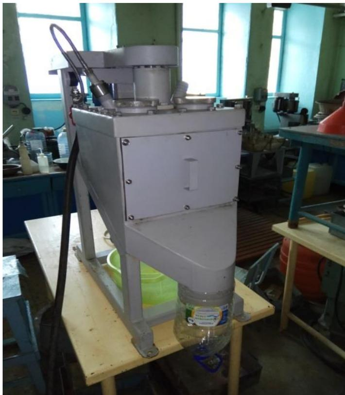
Рисунок 3.1 – Общий вид турбулизационного центробежного сепаратора К – 200ВЛ
