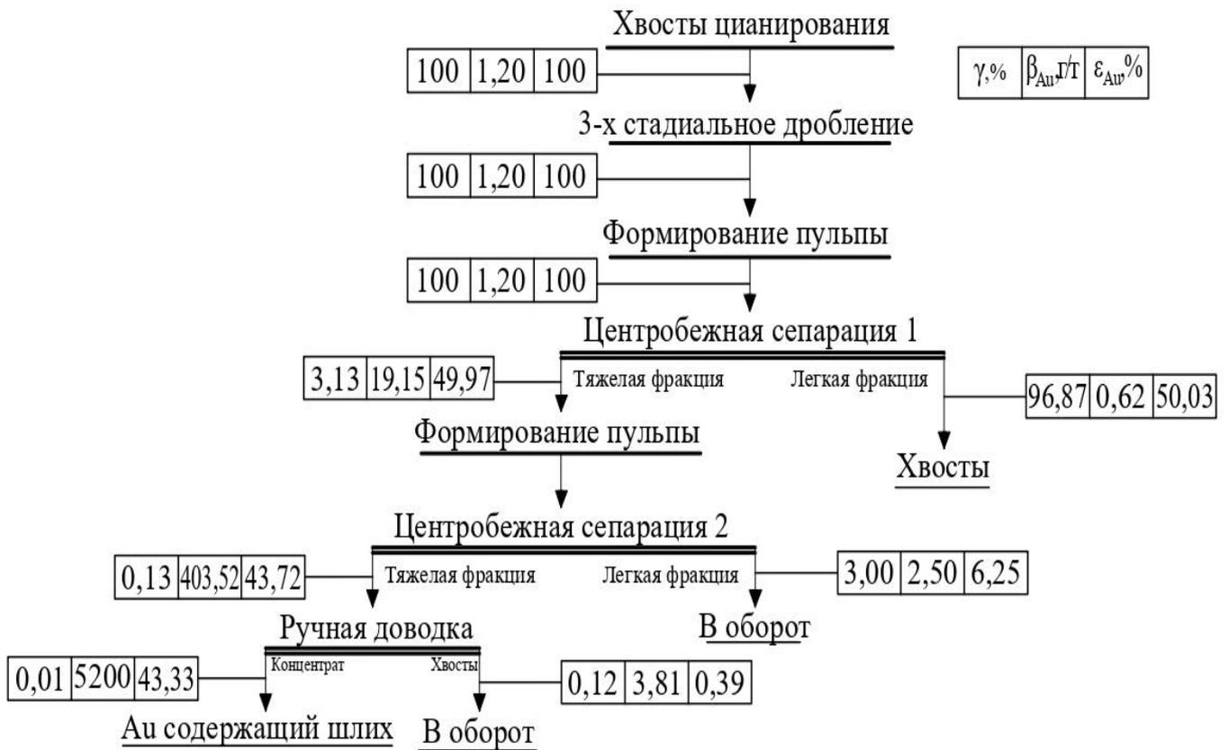
Рисунок 5.4 – Качественно-количественная схема переработки хвостов кучного цианирования руды месторождения «Мизек»
