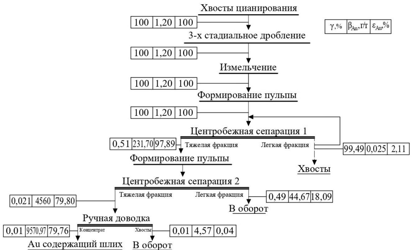
Рисунок 5.7 – Качественно-количественная схема переработки измельченных хвостов кучного цианирования в режиме воздушной турбулизации пристеночного слоя по циркуляционно-накопительной технологии
