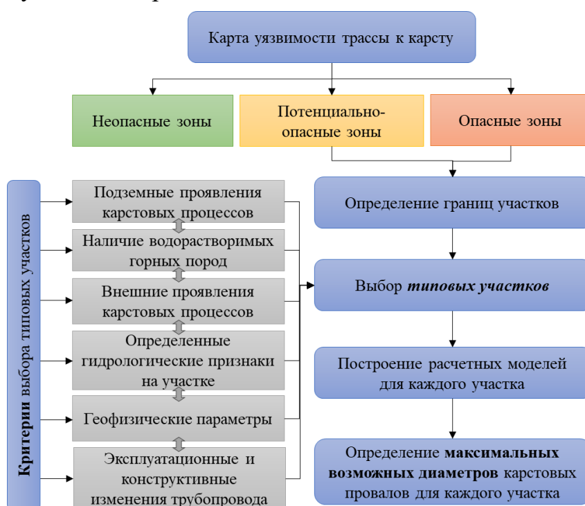
Рисунок 5 – Алгоритм выделения типовых участков карстоопасности и расчета предполагаемых карстовых провалов
