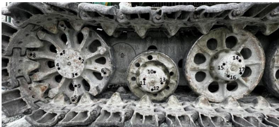
Рис. 6. Места установки преобразователей на колесах
