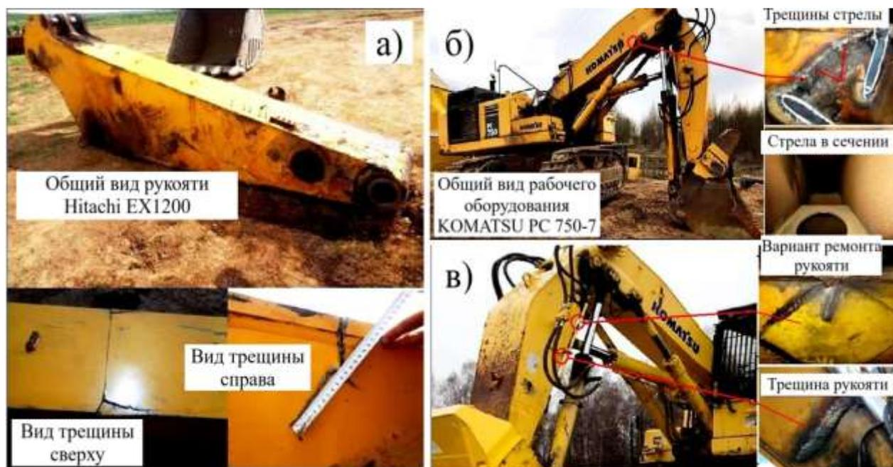
Рисунок 2 – Трещины в рабочем оборудовании гидравлических экскаваторов:
