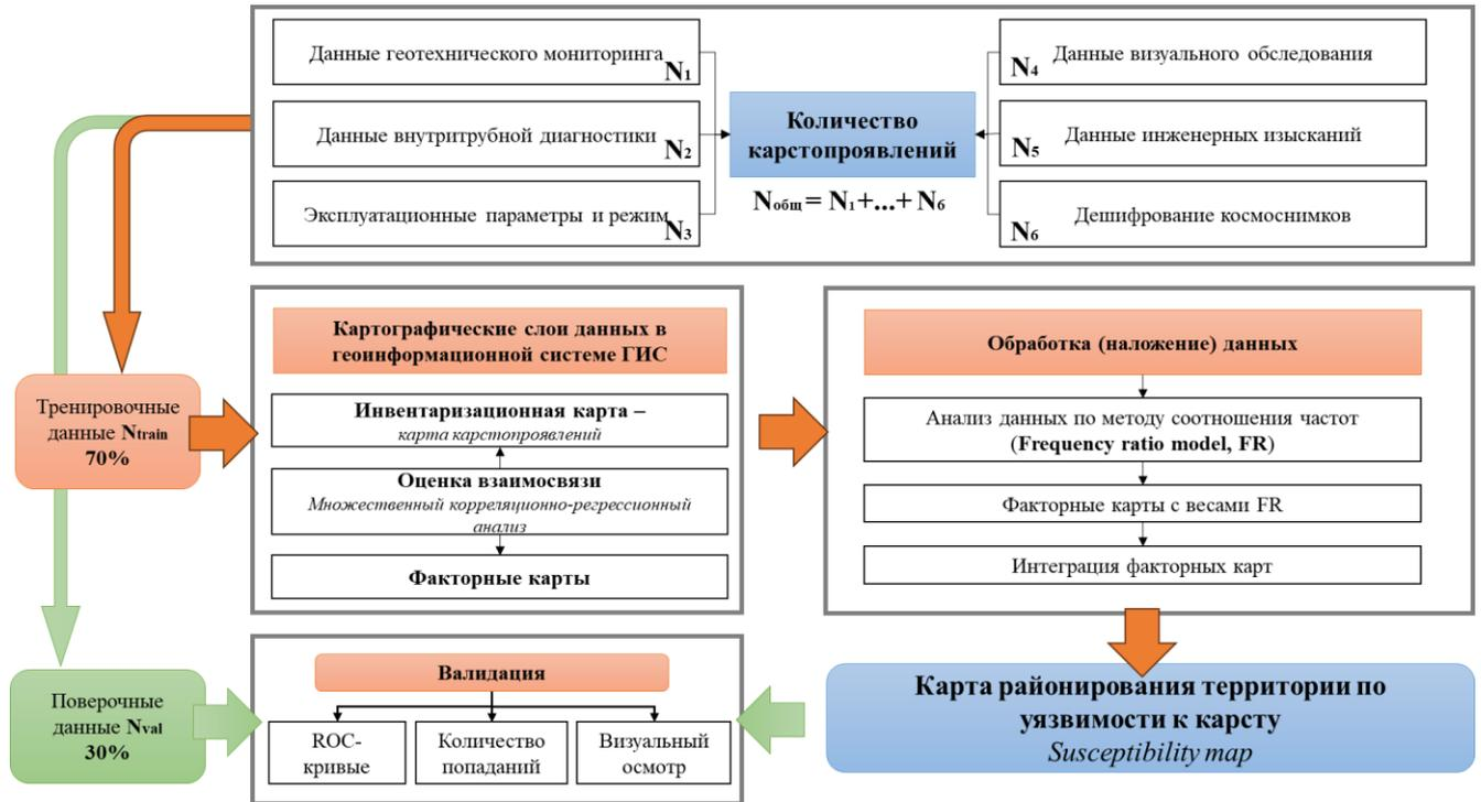
Рисунок 8 – Алгоритм построения карты районирования трассы трубопровода по уязвимости к карсту
