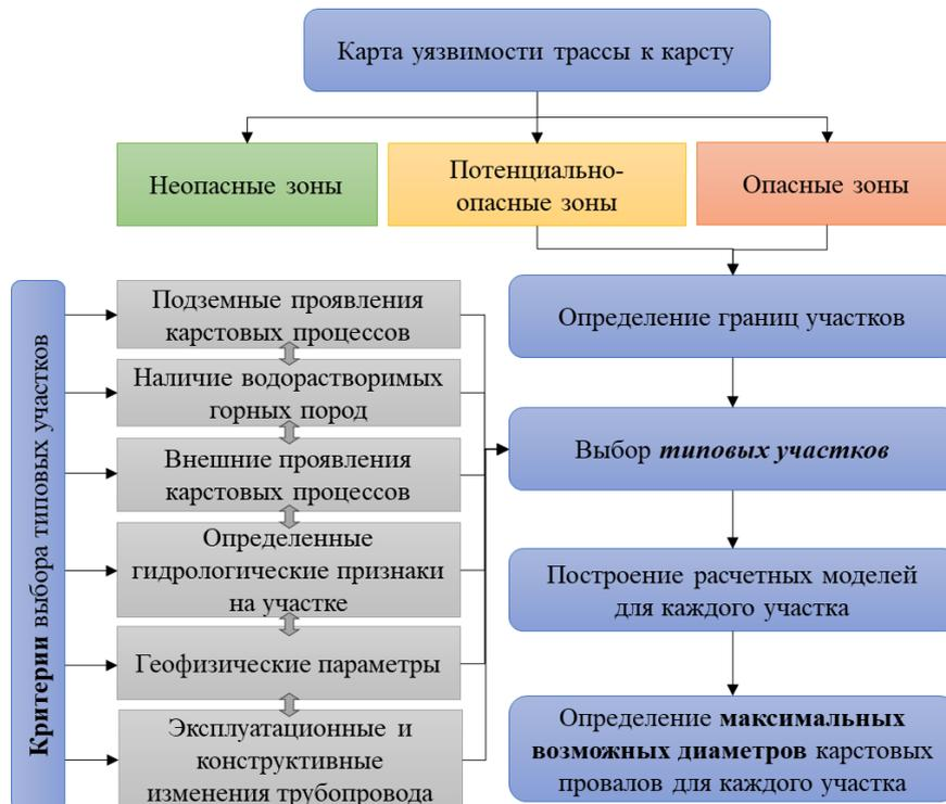
Рисунок 9 – Алгоритм расчета параметров предполагаемых карстовых провалов на типовых участках трубопровода
