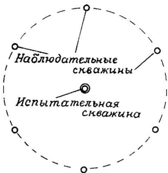
Рис. 9.7. Схема расположения скважин при определении направления и скорости подземных вод методом индикаторов
