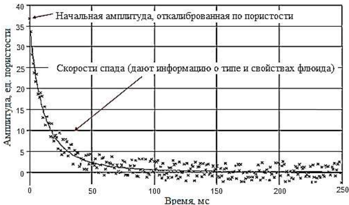
Рис. 7.5. Аппаратурная релаксационная кривая. Отдельные точки - полевые данные, сплошная кривая - их осреднение. Эхо-сигналы записаны со временем между сигналами 1 мсек.
