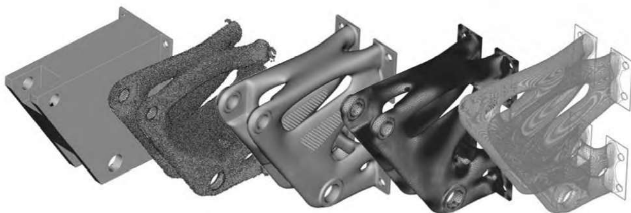
Рисунок 2.3 – Пример оптимизации топологии
