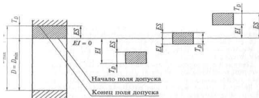
Рис. 1.4. Схема расположения полей допусков отверстий
