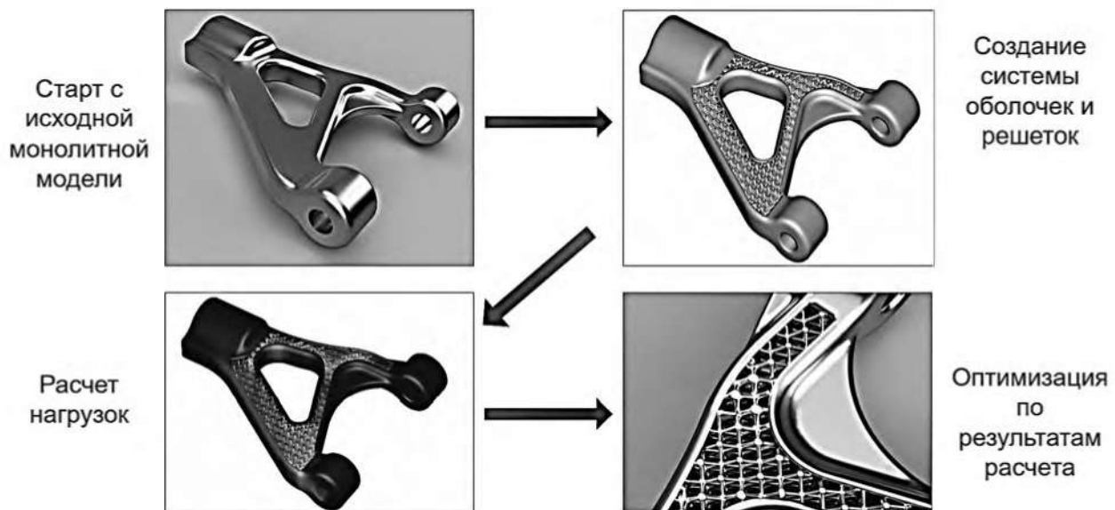
Рисунок 2.1 – Оптимизация структуры крепёжного элемента
